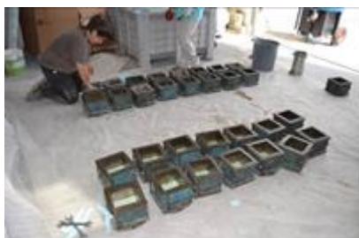
Figura 36- Colocação das placas nos moldes metálicos
