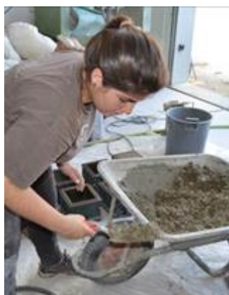
Figura 39- Enchimento dos moldes
