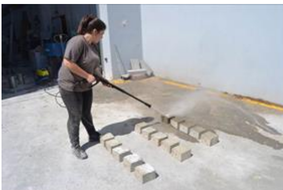
Figura 46- Decapagem de superfícies com tratamento através de jacto de água
