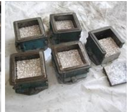
Figura 56- Colocação de substratos na cofragem
