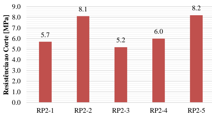
Figura 72- Resistências obtidas nas amostras tratadas com o Retardador de Presa 2
