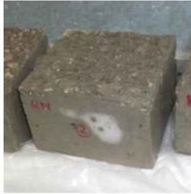
Figura 52- Superfície Raspada. Manualmente
