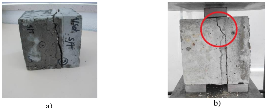
Figura 76- Rotura não esperada nos provetes: a) ST3 e b) RP1-4
