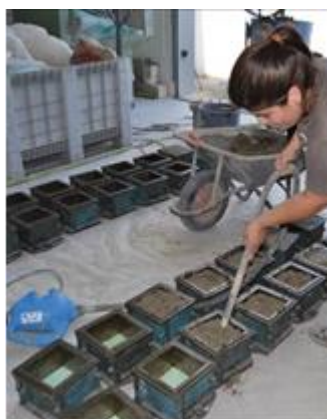
Figura 40- Vibração do betão
