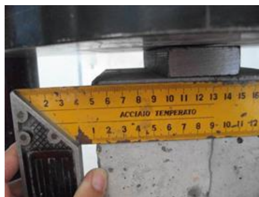
Figura 63- Ajuste da colocação da barra metálica
