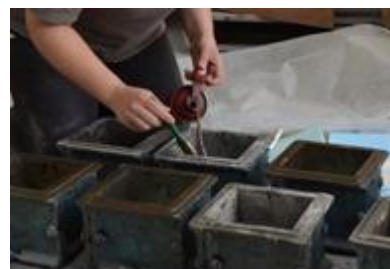
Figura 38- Aplicação de óleo descofrante nas faces interiores
