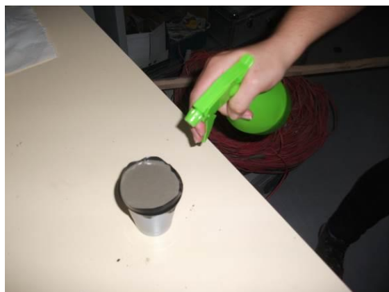
Figura 32- Aplicação das soluções de sacarose
