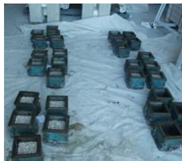
Figura 57- Moldes antes da betonagem
