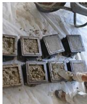
Figura 41- Alisamento de superfícies
