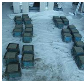
Figura 58- Moldes após betonagem
