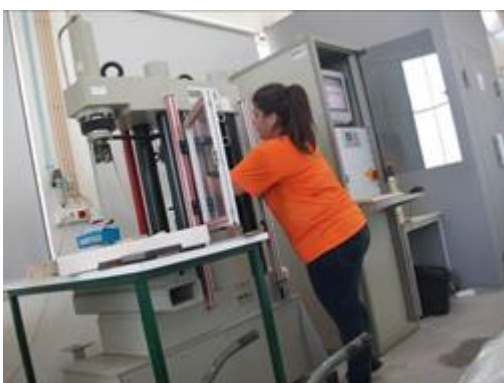
Figura 62- Colocação de provetes na Prensa
