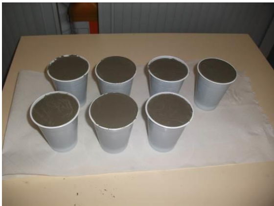
Figura 30- Conjunto de moldes com calda de cimento
