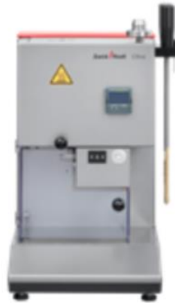
Figura 20 – Plastómetro de Extrusão - Equipamento de medição do índice de fluidez
