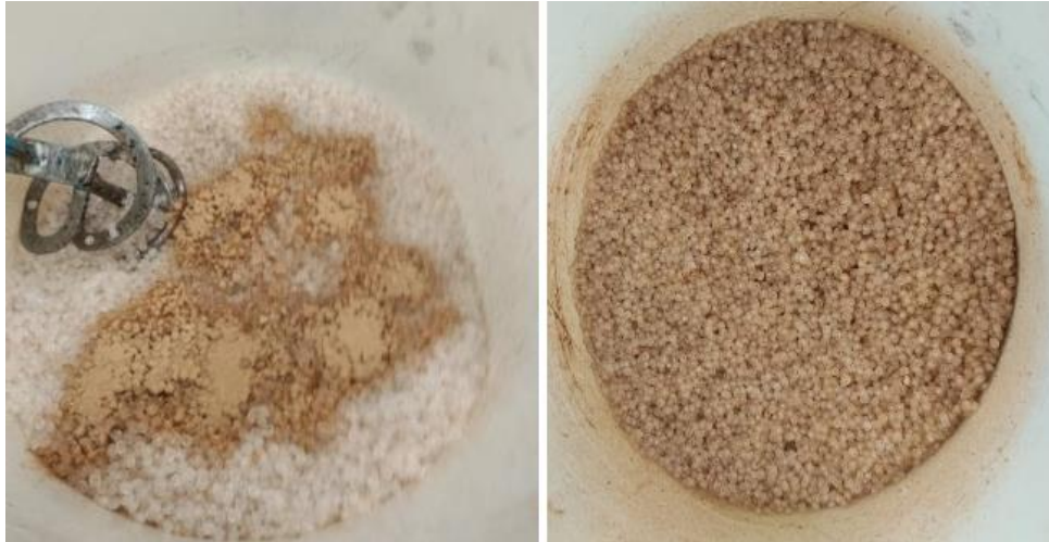
Figura 17 - PP com carga de argila
