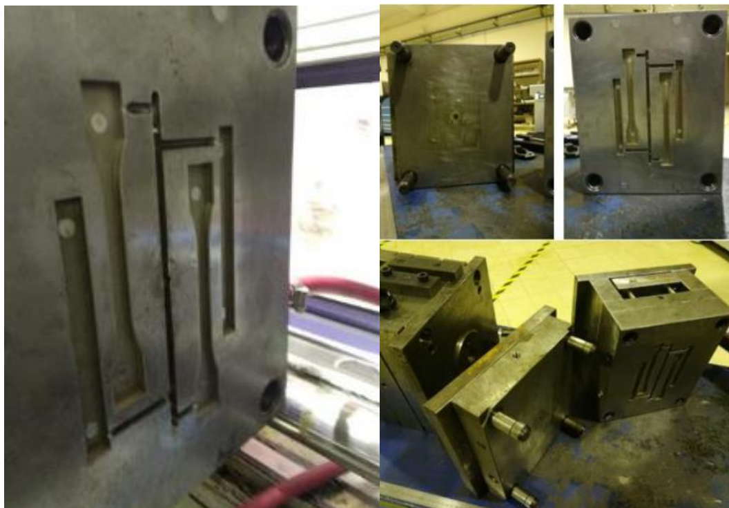
Figura 10 - Molde - Zonas moldantes
