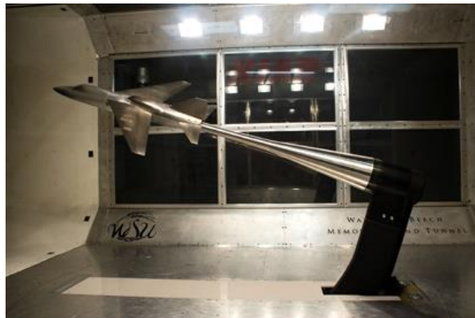
Figura 2.36 – Balança externa com montagem de modelo inteiro com estrutura de suporte (NIAR's Beech Wind Tunnel unveils new sting mount system, 2008).
