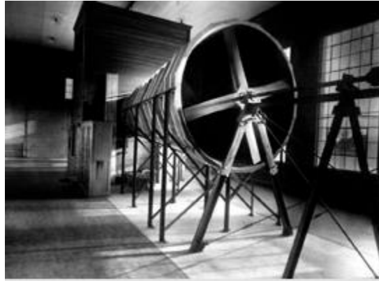
Figura 2.20 – Primeiro túnel de vento localizado no NASA Langley Research Center (Dumber, 2020).
