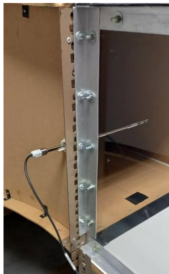
Figura 4.1 – Sensor posicionado com 25 cm de introdução.
