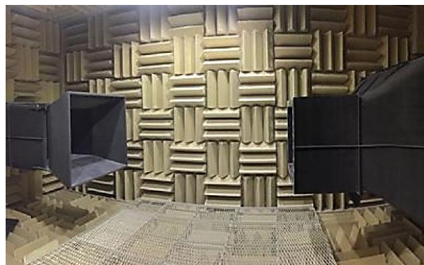
Figura 2.30 – Secção de ensaios aberta equipada com uma câmara anecoica (UKRI Science and Technology Facilities Council, 2020).
