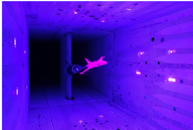
Figura 2.32 – Teste PSP numa secção de ensaios fechada na Associação de Pesquisa de Aeronaves em Inglaterra (Innovative Scientific Solutions, 2020).
