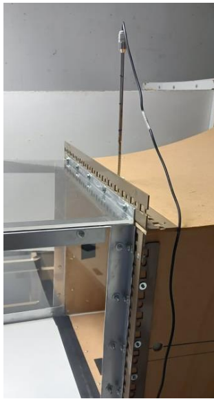
Figura 3.22 – Local de instalação do anemómetro.
