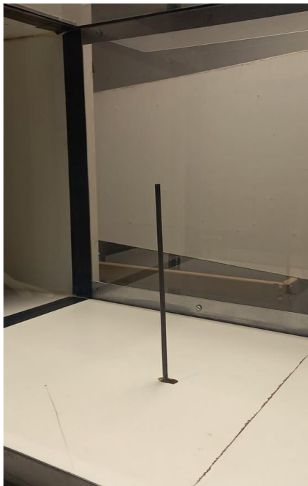
Figura 4.13 – Medição da F_D no cilindro com a A_{ST} do suporte.
