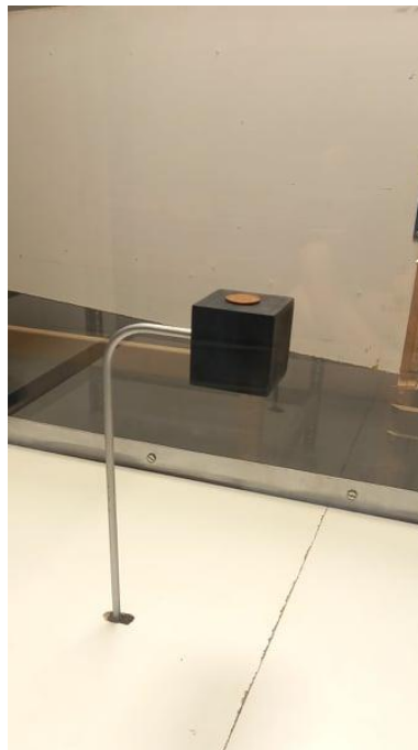
Figura 4.15 – Aplicação de um peso conhecido sobre o suporte.
