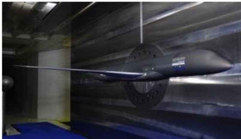
Figura 2.35 – Balança externa de parede lateral com montagem meio-modelo (FF Pieterse, 2017).
