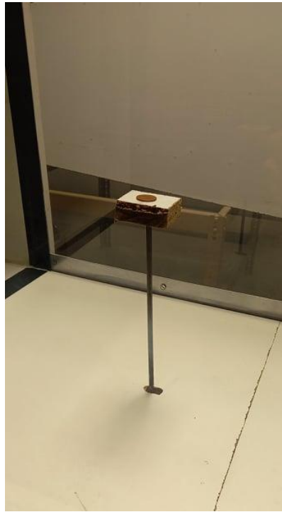
Figura 4.14 – Aplicação de um peso conhecido sobre o cilindro.
