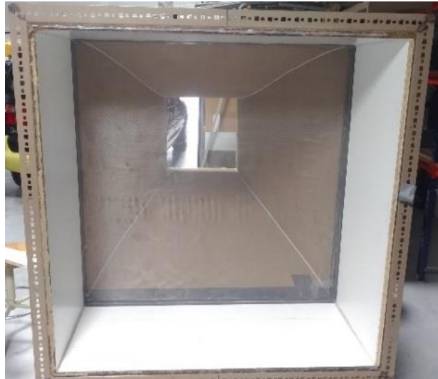
Figura 3.7 – Colocação da tela de laminarização de malha mais fina.
