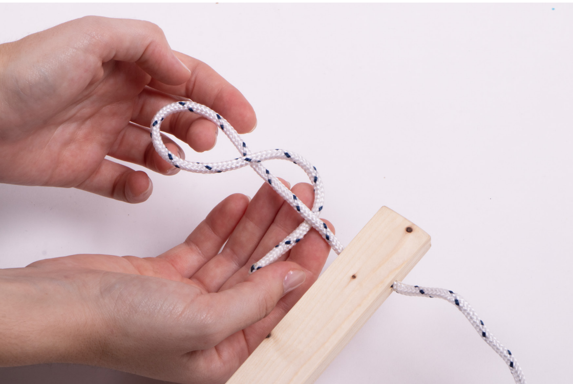
FIG. 98 Aplicação do nó em oito numa das extremidades da corda para fixação.
