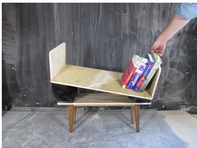
Imagem 50 - Modelo teste da estante com o tecido composto de dois materiais diferentes
