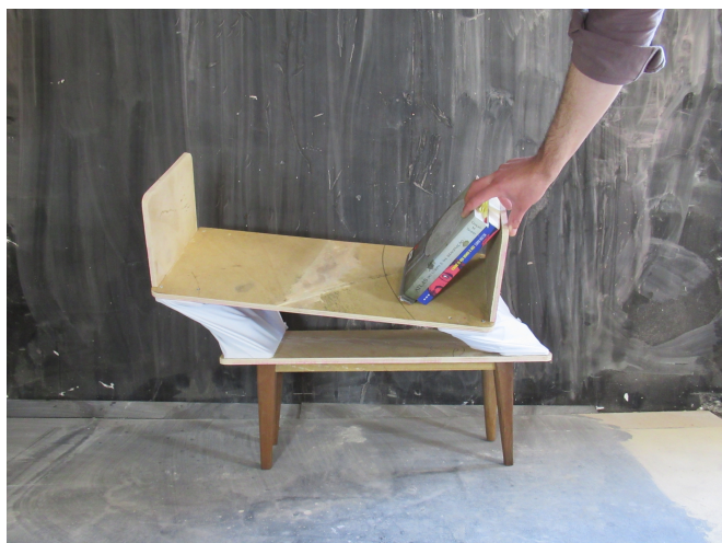
Imagem 49 - Modelo teste da estante com estrutura em lycra
