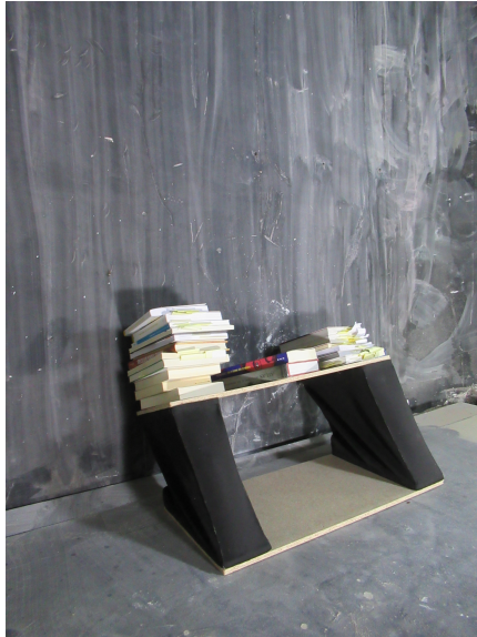
Imagem 51 - Modelo teste da estante com dobradiças na estrutura
