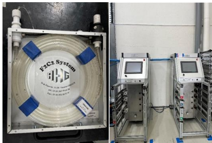
Figura 13 - Cassetes de rebites F2C2 (esquerda) Estações de carregamento automáticas (direita)
