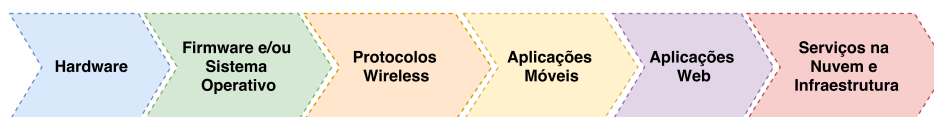
Figura 5: Metodologia a seguir para avaliar a segurança de um dispositivo IoT. Adaptado de Dixit (2017)
