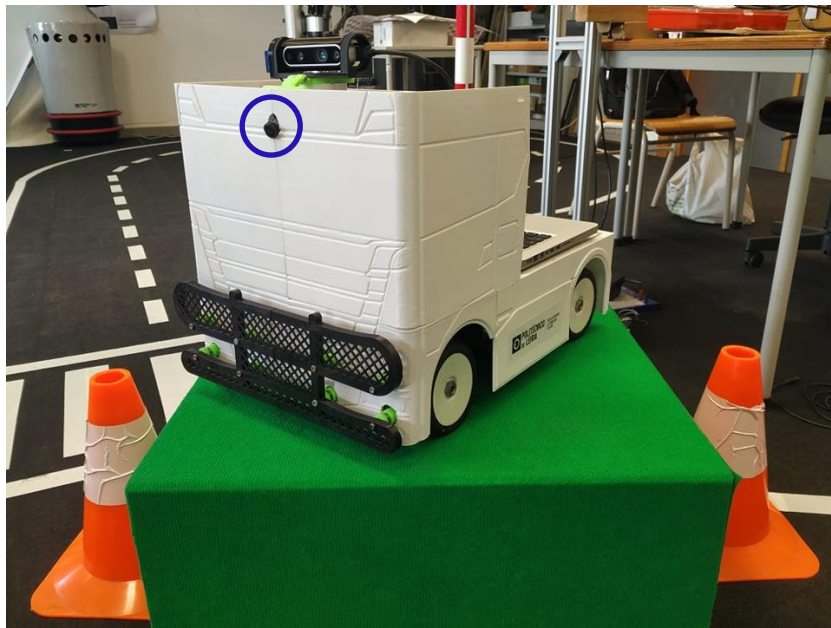
Figura 6 - Veículo de condução autónoma do Clube de Robótica, assinalado com um círculo azul encontra-se a câmara frontal.
