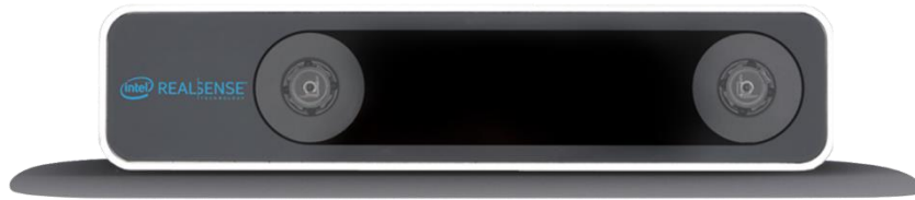
Figura 47 - Câmara Intel RealSense T265 [29].
