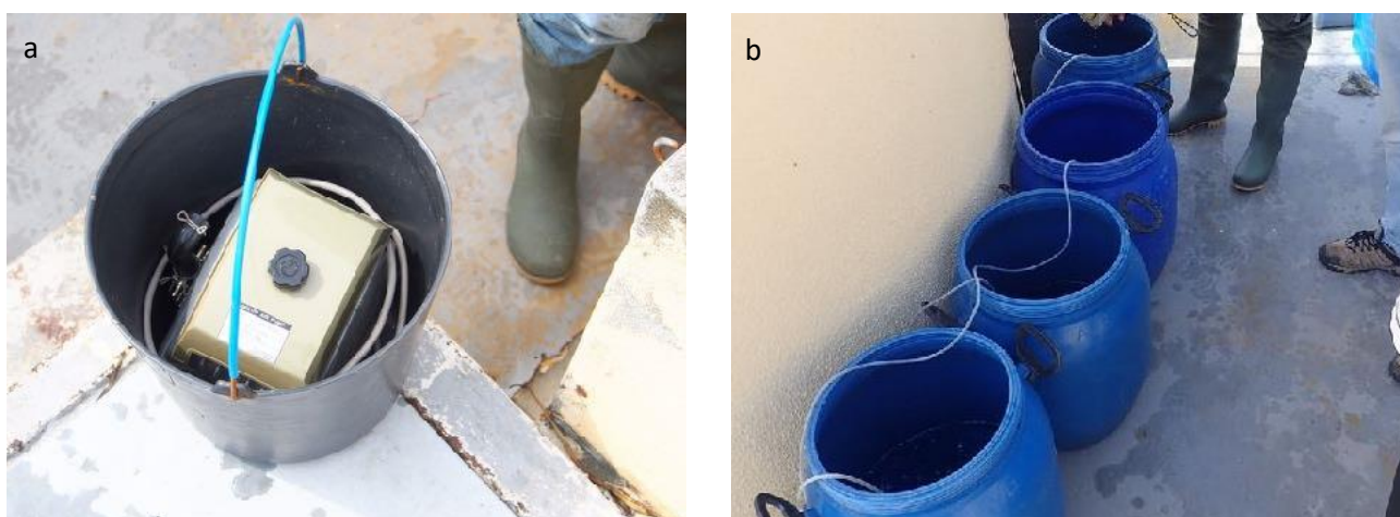
Figura 4 - a) Arejador; b) Recipientes provisórios com arejamento. O arejamento deve ser o suficiente para arejar os indivíduos mas insuficiente para causar demasiada agitação na superfície da água que possa provocar danos.
