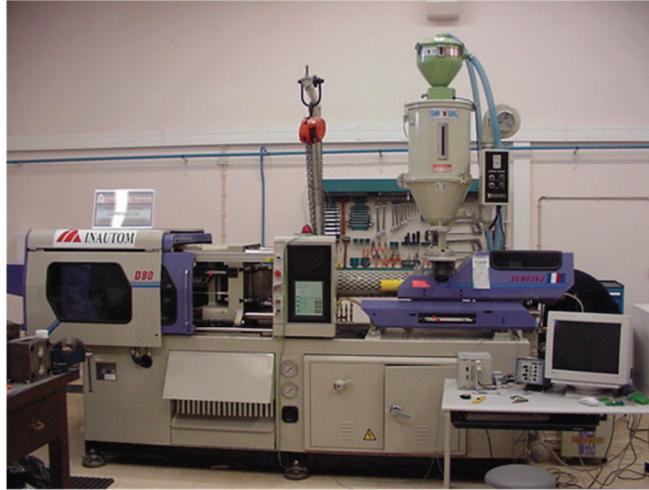
Figura 4.1 – Máquina de injeção Euro Inj Série D-080 da Lien Yu.
