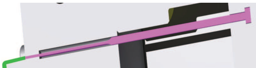
Figura 2.43 - Extrator laminar aplicado num rib de uma peça plástica.
