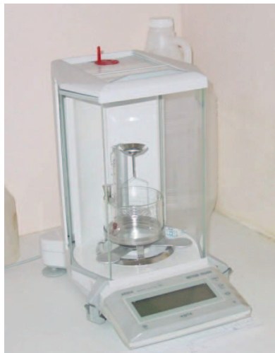
Figura 4.6 – Balança eletrônica de precisão usada na determinação das densidades.
