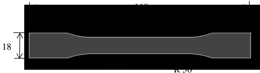
Figura 4.2 – Geometria dos provetes de tração (dimensões em mm).
