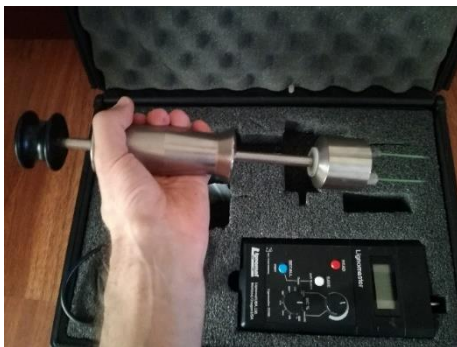
Figura 18 – Exemplo da utilização do humidímetro durante as inspeções
