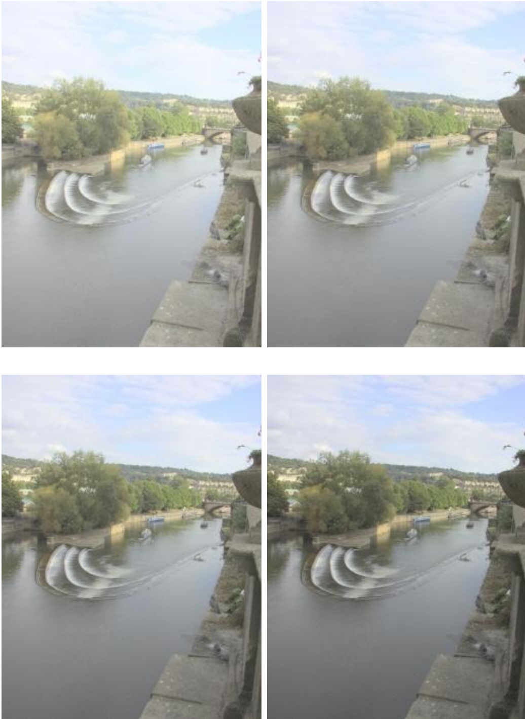
Figura 2.23 TMO do Drago et al aplicado a uma imagem HDR variando o parâmetro bias : 0.6, 0.7, 0.85 e 1 (imagem original livro HDRI - [Reinhard'05b]).
