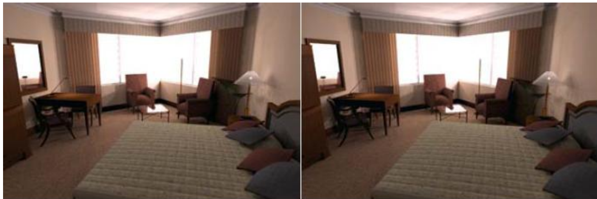
Figura 2.38 À esquerda, a imagem mapeada obtida pela aplicação do algoritmo Tumblin et al original e, à direita, a versão obtida por hardware gráfico (imagem original [Artusi'03]).
