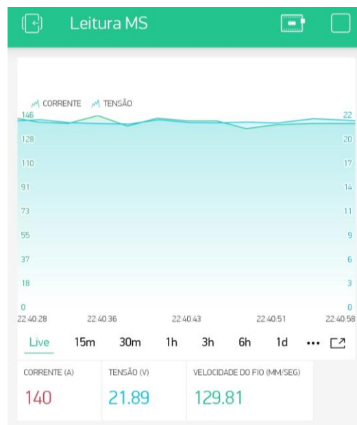
Figura 52 - Aplicação Blynk com valores durante os ensaios do Provette 2
