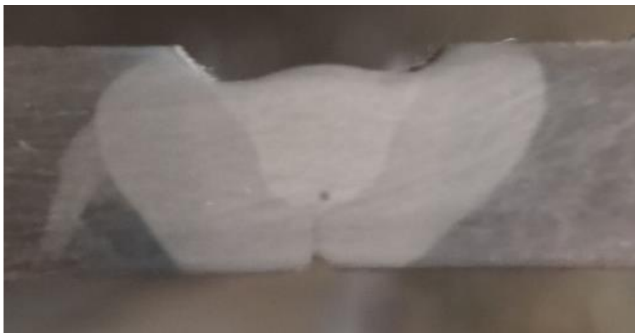
Figura 62 - Ensaio Macrográfico do Provete 2
