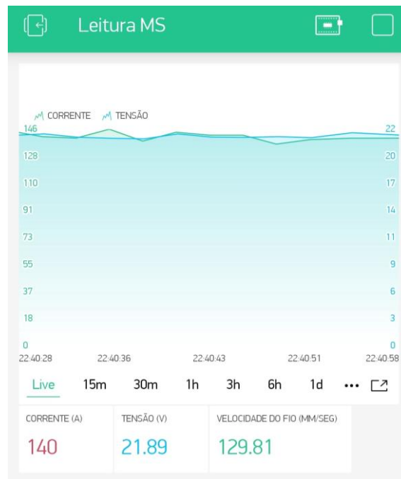
Figura 31 - Apresentação das medições através da aplicação Blynk
