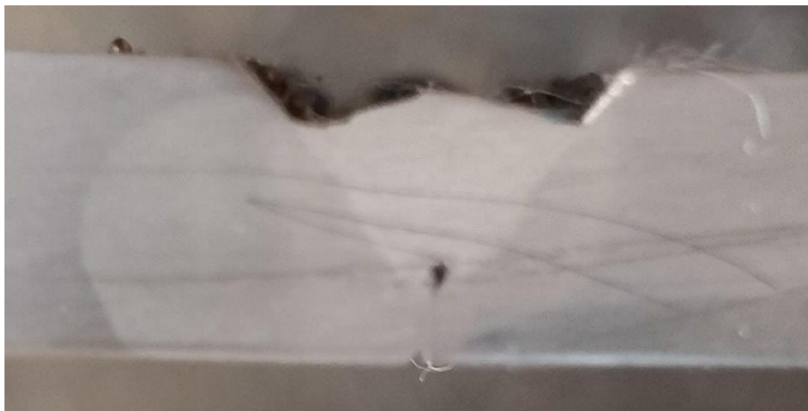
Figura 64 - Ensaio Macrográfico do Provete 3
