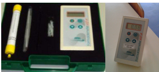
Figura 15 - Medidor Portátil Formaldemeter htV-M e calibrador
