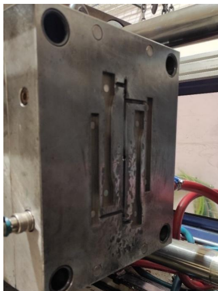
Figura 26 - Cavidade do molde
