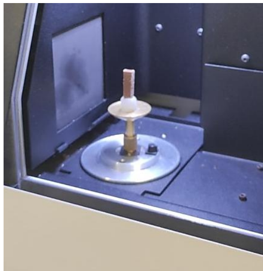
Figura 38 – Amostra peça impressa em 3D na máquina de Micro-CT
