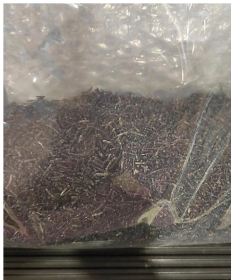
Figura 24 – Compósito 1 granulado obtido no processo de extrusão
