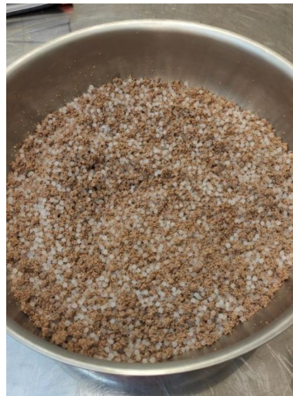
Figura 21 – Combinação do Material Compósito 2 (PLA + 40% Cortiça)
