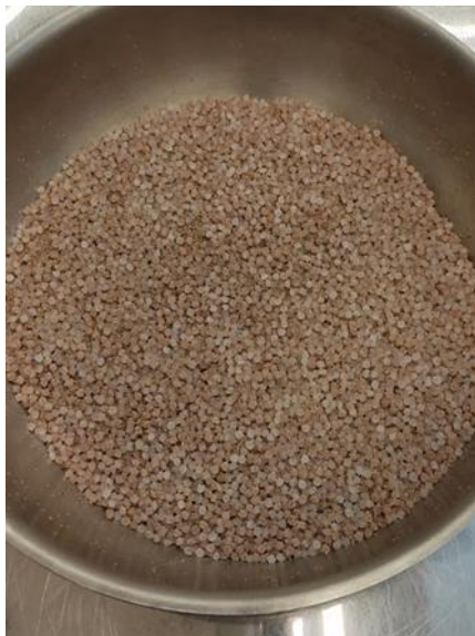
Figura 20 – Combinação do Material Compósito 1 (PLA + 30% Cortiça)
