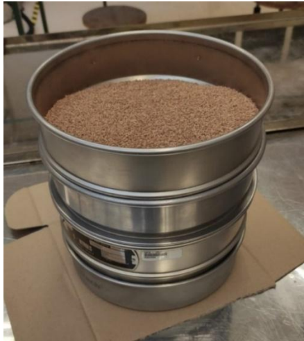
Figura 18 – Processo de peneiração da cortiça
