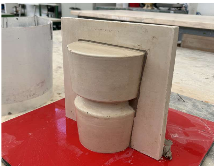
Imagem 83- Conformação do molde do assador em gesso. Fonte: Autora
