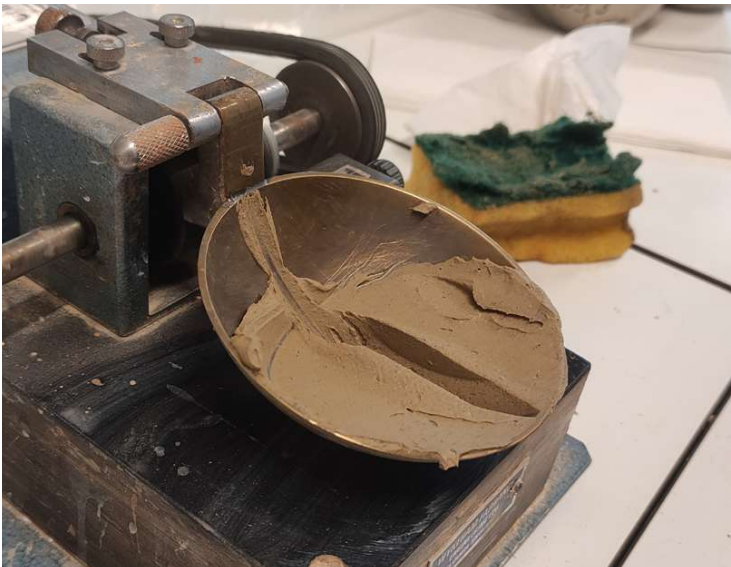
Imagem 81- Teste de plasticidade na concha de CasaGrande. Fonte: Autora
