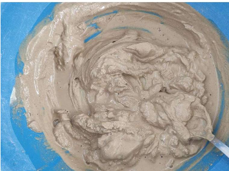
Imagem 65 - Mistura do barro peneirado com água até formar uma pasta líquida. Fonte: Autora
