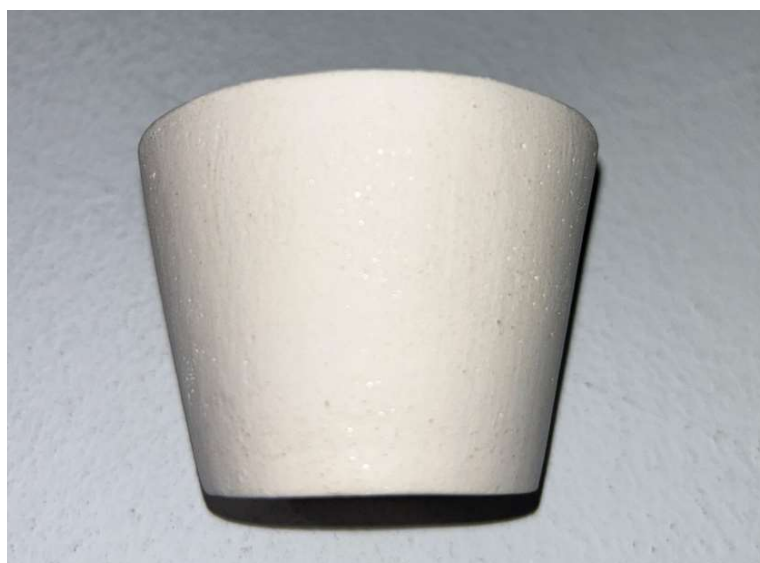
Imagem 76 - Peça após cozedura a 980°. Fonte: Autora
