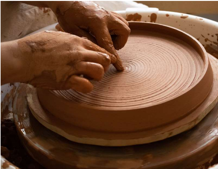
Imagem 105 - Modelação do prato na roda de olaria. Fonte: Autora
