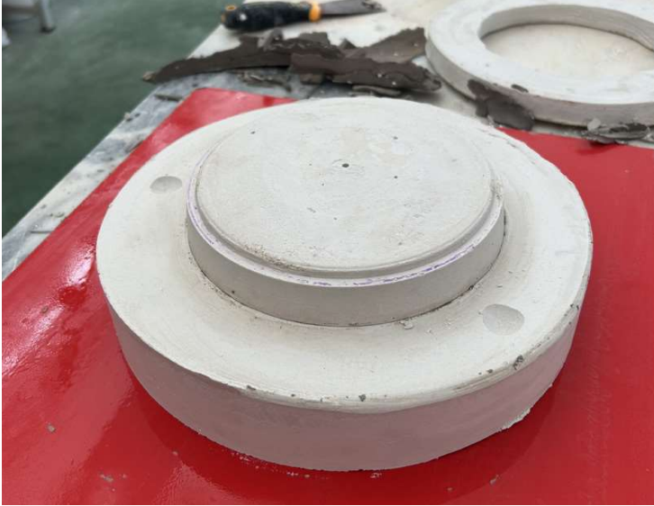
Imagem 84- Confomação do molde do prato em gesso. Fonte: Autora
