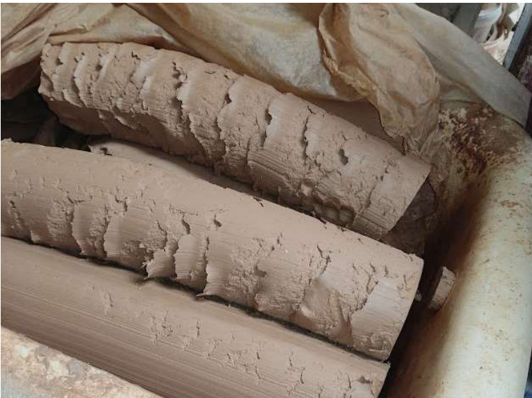
Imagem 55 - Barrotes de barro de Moveros após passarem pela extrusora. Fonte: Autora
