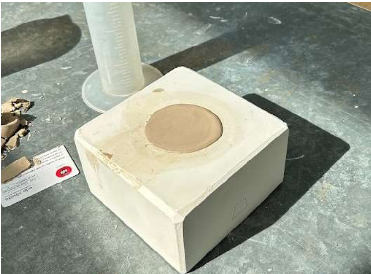
Imagem 73 - Enchimento do molde com a pasta. Fonte: Autora
