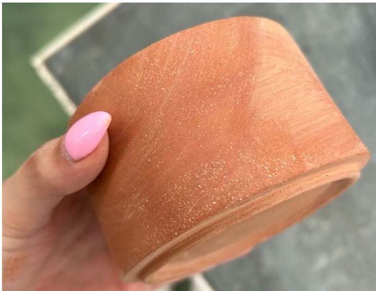
Imagem 77 - Peça feita a partir de enchimento com barbotina de barro de Paredes com barro vermelho
