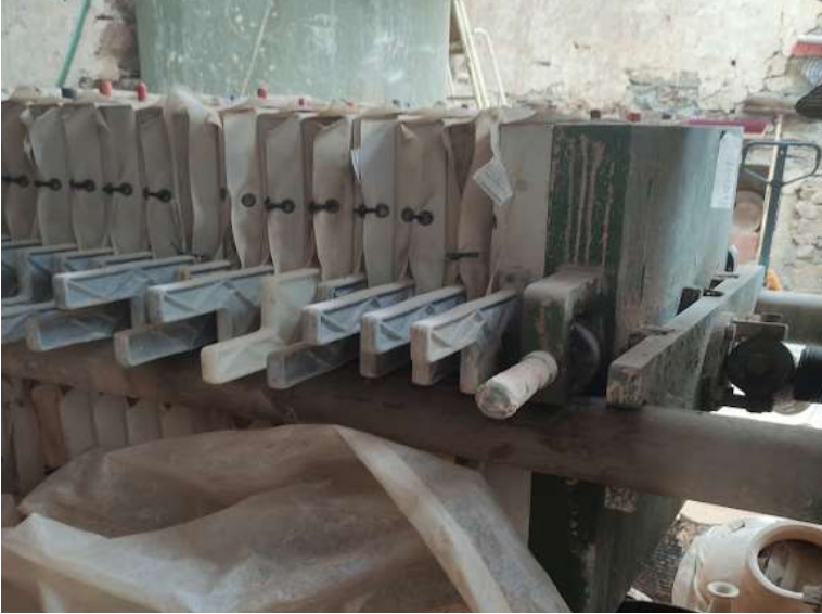
Imagem 54 - Máquina composta por vários filtros que limpam as impurezas da pasta. Fonte: Autora
