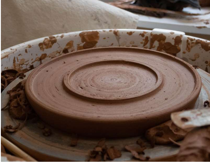
Imagem 93- Acabamentos do prato (fretes para suporte e encaixe). Fonte: Autora
