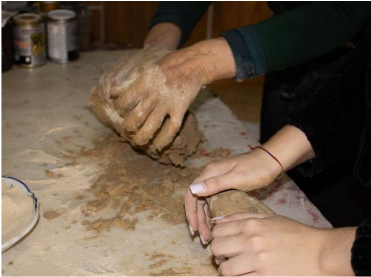
Imagem 48- Processo de amassar o barro de Pinela. Fonte: Autora
