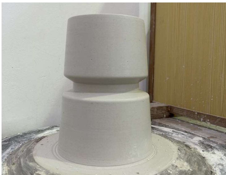
Imagem 82 - Modelação do modelo no torno de gesso. Fonte: Autora
