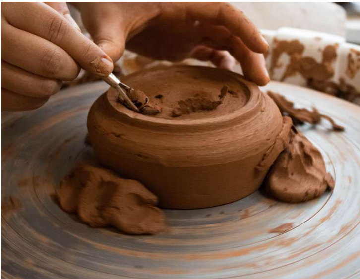
Imagem 118- Acabamentos (frete e encaixe do fundo). Fonte: Autora
