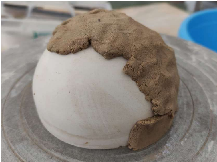
Imagem 62 - Processo 2- Conformação por sobreposição de barro em molde de gesso. Fonte: Autora
