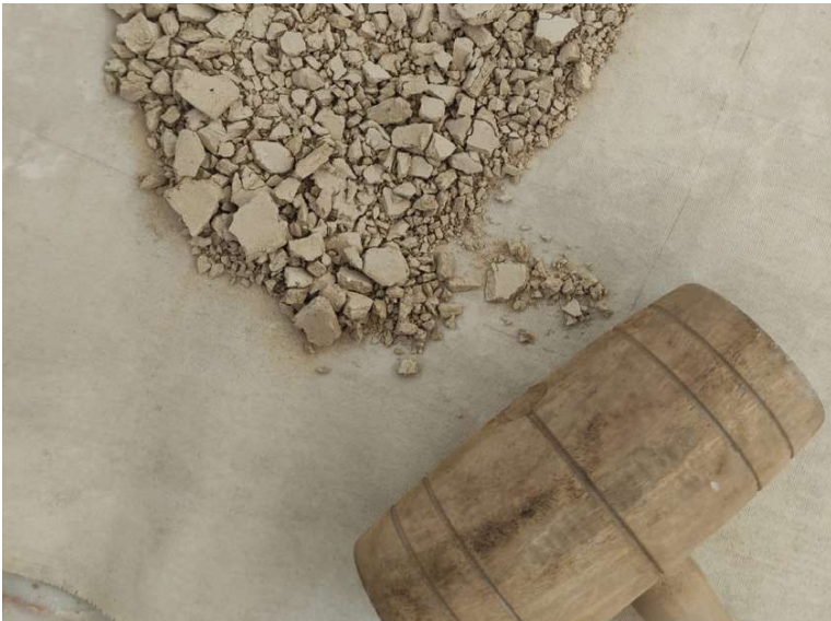
Imagem 63- Processo de moer o barro com um maço de madeira Fonte: Autora
