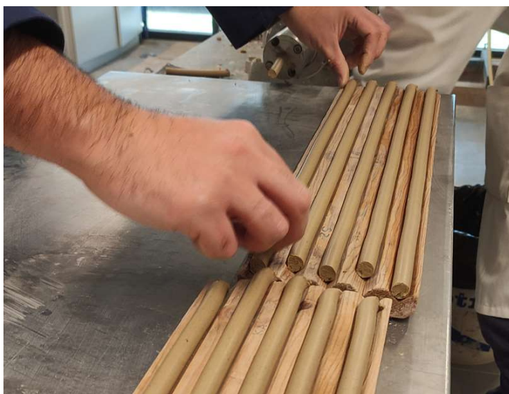
Imagem 79\80 - Processo de extrusão dos provetes. Fonte: Autora
