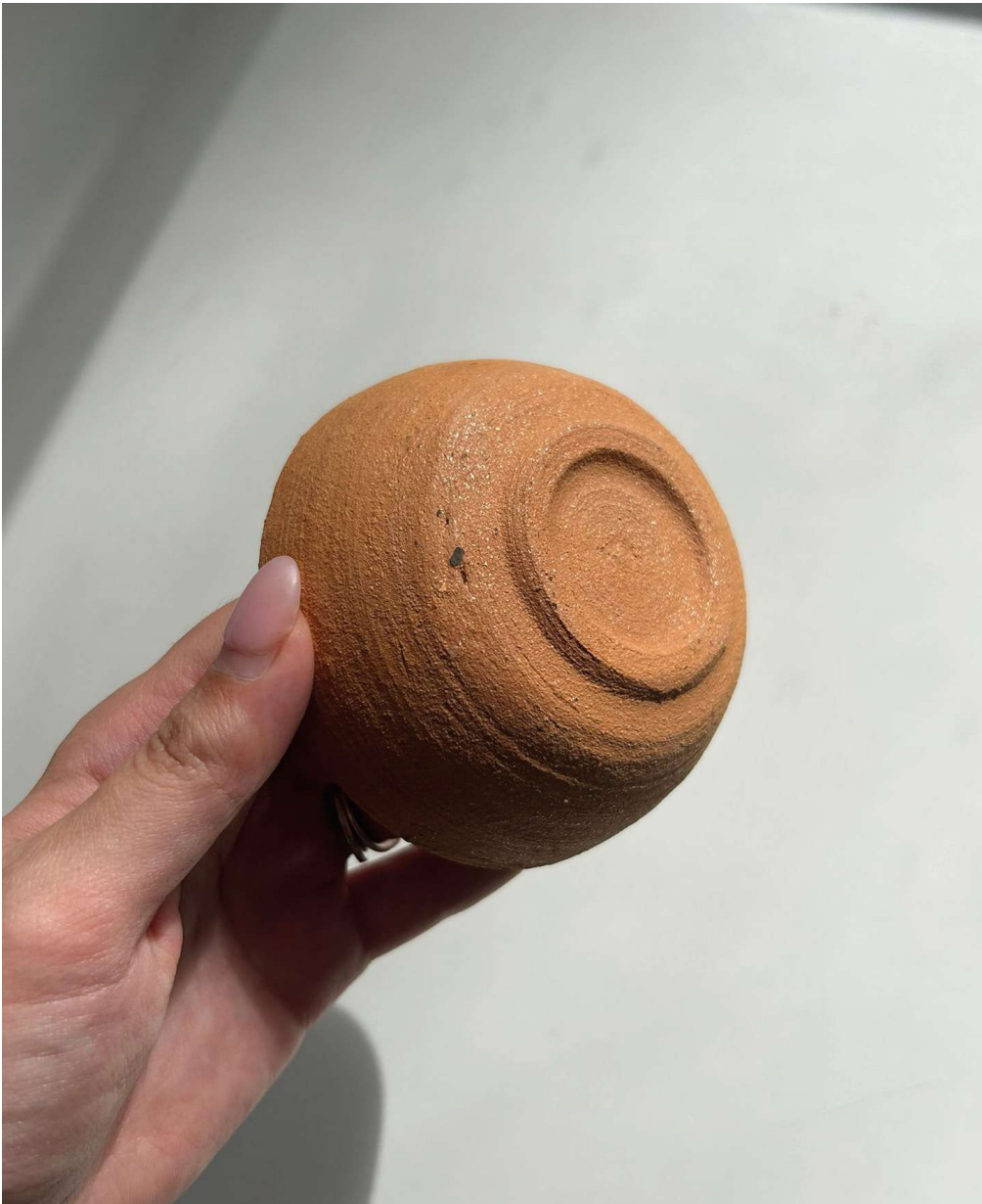
Imagem 61- Processo 1- Conformação por roda de olaria (peça cozida a 980°) Fonte: Autora
