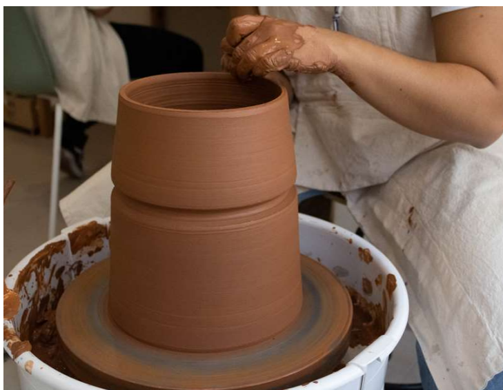
Imagem 90- Modelação do assador na roda de olaria. Fonte: Autora
