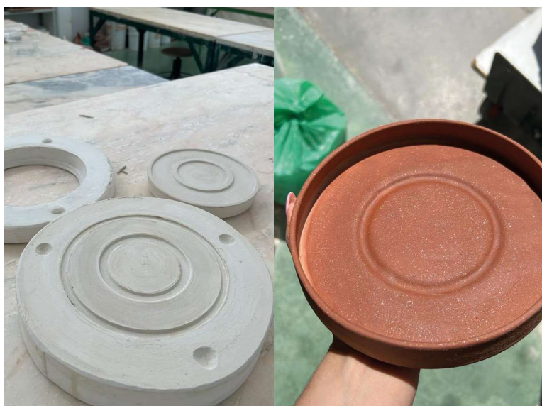
Imagem 59\60 - Processo de conformação por enchimento de molde de gesso com pasta líquida (barbotina).
