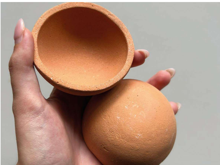
Imagem 68- Peças de enchimento cozidas a 980°. Fonte: Autora
