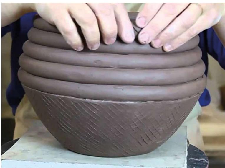
Imagem 58 - Processo de conformação por rolo Fonte: Bamboo Tools Pottery
