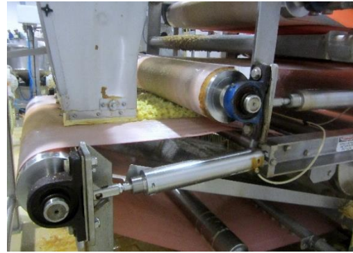
Figura 3.6 – Prensa pneumática de esteira contínua ( belt press ) (Fotografia de Ana Teresa Marques)
