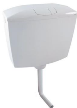
Figura 24 : Exemplo de autoclismo exterior de dupla descarga com regulação do volume de descarga (3/6 - 3/9 litros), de classe de eficiência A de acordo com as exigências da ANQIP (Catálogo OLI)
