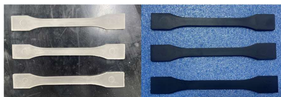
Figura 26 - Provetes utilizados como masters na construção do molde de silicone. À esquerda, estão os provetes antes dos acabamentos e à direita os provetes já estão prontos a serem utilizados.
