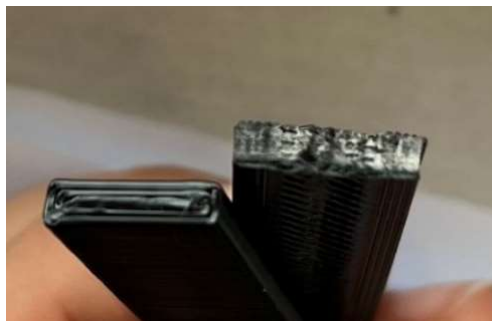
Figura 50 - Tipos de quebra obtidos durante os ensaios de flexão
