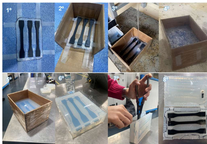
Figura 27 - Construção do molde de silicone. 1º-Criação da linha de junta; 2º-Fixação os masters na caixa e criação dos canais de alimentação; 3º- Enchimento do molde; 4º- Desgaseificação do silicone; 5º- Cura do silicone; 6º-Molde retirado da caixa; 7º- Abertura do molde; 8º- Molde aberto.
