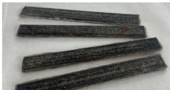
Figura 35 - Provetes de PLA com reforço de fibras de linho ainda em excesso.
