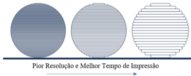
Figura 10 - Efeitos da altura das camadas na resolução e tempo de impressão. Adaptado de [23].
