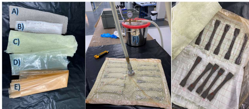
Figura 34 - Reforço dos provetes de PLA. A) Fibra de linho; B) Tecido de poliamida - Peel ply ; C) Material absorvente - Breather ; D) Filme perfurado; E) Saco de vácuo; F) Panela de vácuo.
