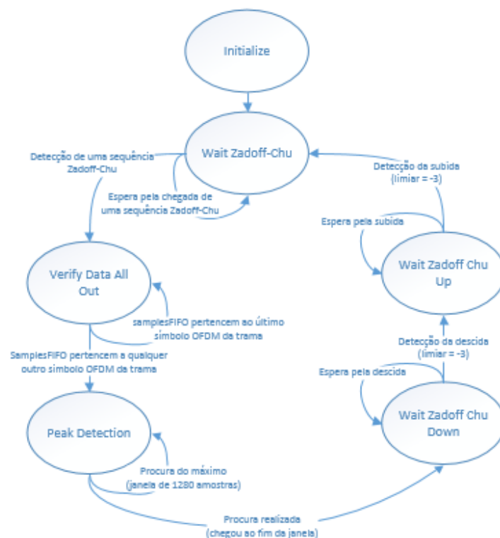
Figura 4.14: Diagrama de estados da máquina de estados Peak_Detector .
