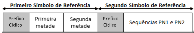
Figura 3.2: Constituição dos símbolos de referência propostos por Schimdl & Cox para estimação do início de trama e CFO.
