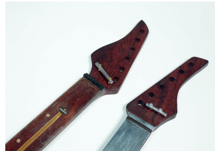
Fig. 115 - Processos de produção dos protótipos: montagem de string trees nos protótipos “Braço Aço” e “Braço Vidro”.
