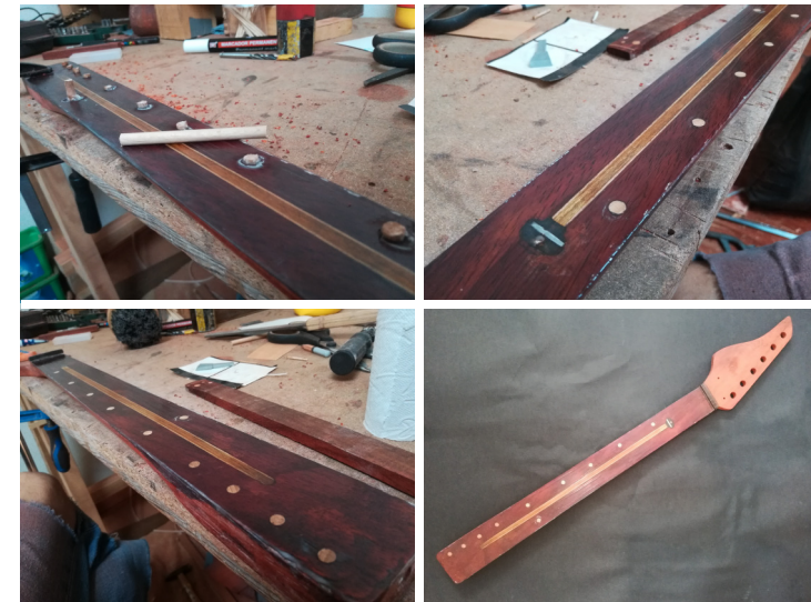
Fig. 111 - Processos de produção dos protótipos: entalhes em madeira de Faia para marcação da escala do braço de guitarra.
