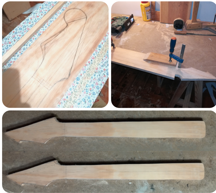
Fig. 58 - Processos de produção de maquetes - Corte do headstock e corpo do braço.
