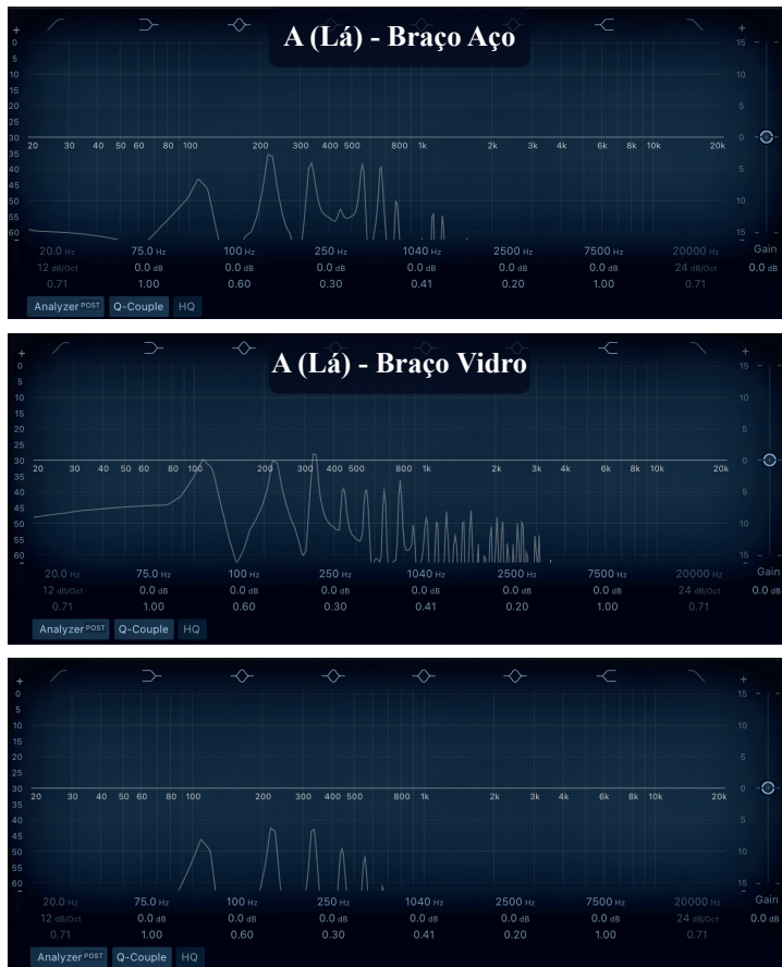
Fig. 148 - Ensaio de comparação sonora entre protótipos “Braço Aço”, “Braço Vidro” e um braço de guitarra com trastes - (Lá - corda solta).
