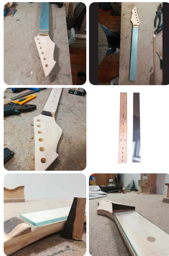
Fig. 63- Processos de produção de maquetes - Colagem de fretboards e pestanas (2).
