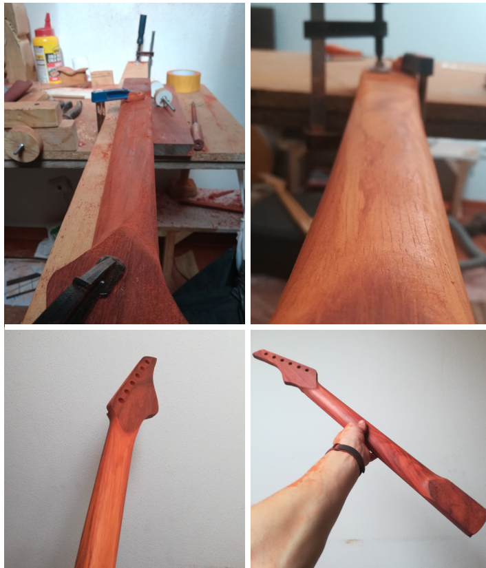
Fig. 92 - Processos de produção dos protótipos: lixagem e pré-acabamento das peças de madeira.
