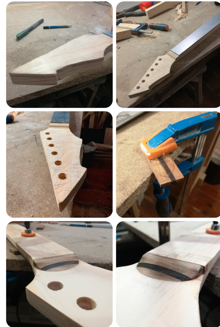
Fig. 59 - Processos de produção de maquetes - Rebaixo e entalhe do headstock .
