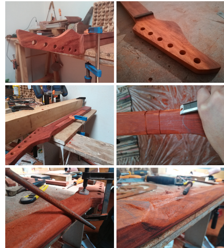
Fig. 91 - Processos de produção dos protótipos: corte e furação da forma das cabeças dos braços e desbaste da parte traseira em forma de “C”.
