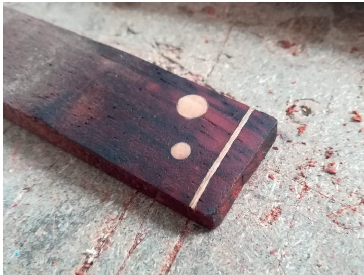
Fig. 110 - Experiência de entalhe de cavilha de madeira de Faia em madeira de Curupixá.
