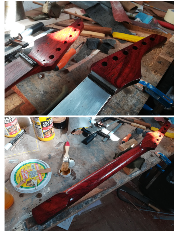
Fig. 113 - Processos de produção dos protótipos: tratamento das madeiras com mistura de óleo mineral com cera de abelha (1).
