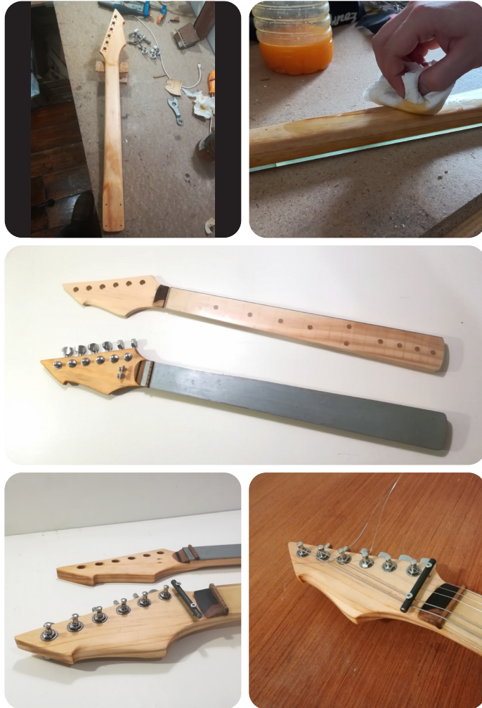
Fig. 64 - Processos de produção de maquetes - Lixagem, acabamento e montagem de afinadores e string trees .
