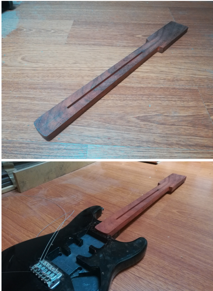
Fig. 90 - Processos de produção dos protótipos: teste de encaixe com corpo de guitarra.
