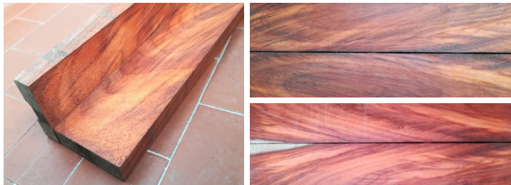
Fig. 88 - Madeira de Curupixá utilizada para a produção dos protótipos de braços de guitarra.
