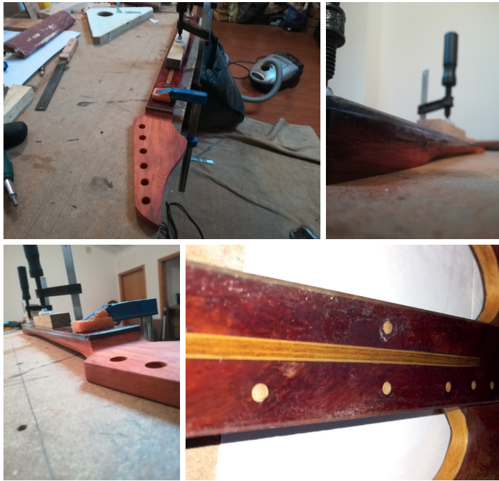
Fig. 112 - Processos de produção dos protótipos: nova colagem da escala de vidro no braço de guitarra.
