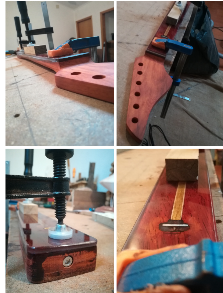
Fig. 106 - Processos de produção dos protótipos: colagem das escalas ao corpo do braço da guitarra (1).
