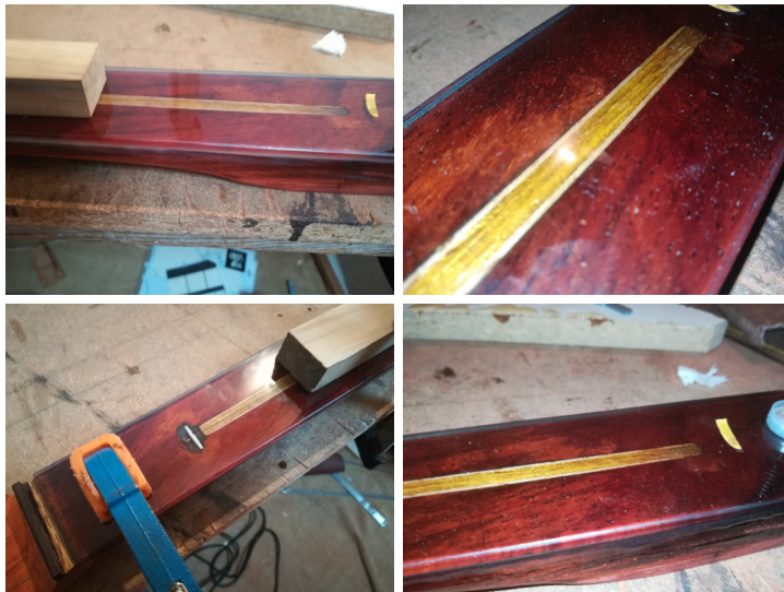
Fig. 107 - Processos de produção dos protótipos: colagem das escalas ao corpo do braço da guitarra (2).
