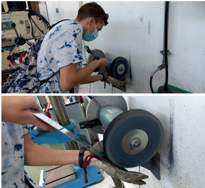
Fig. 100 - Processos de produção dos protótipos: processos de produção da escala de chapa de aço (polimento).
