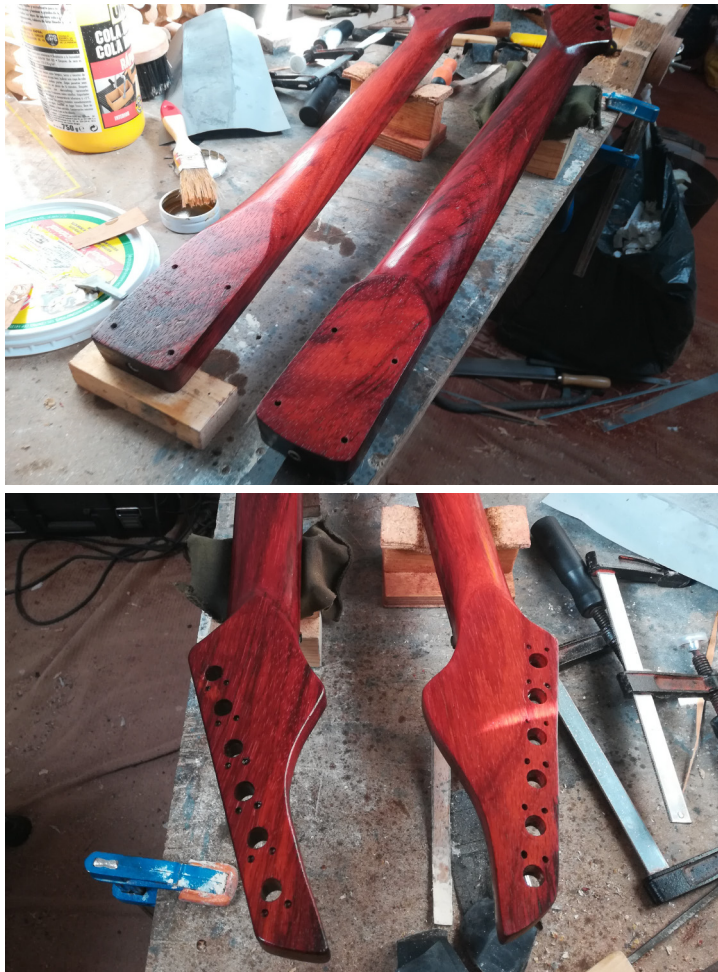
Fig. 114 - Processos de produção dos protótipos: tratamento das madeiras com mistura de óleo mineral com cera de abelha (2).
