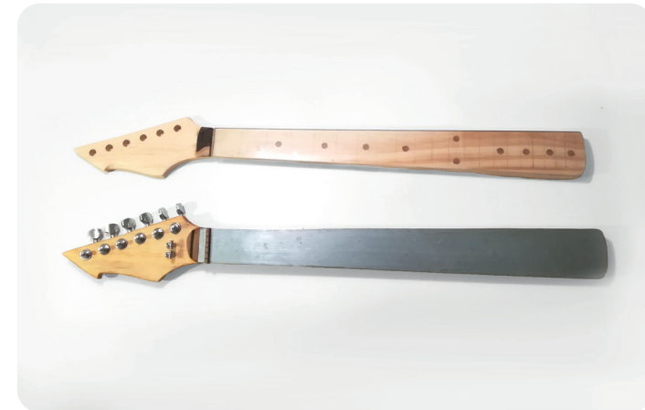
Fig. 65 - Montagem de afinadores, pestana e string trees nos braços (1).
