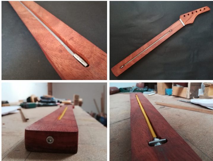
Fig. 96 - Processos de produção dos protótipos: teste de encaixe dos truss rods .
