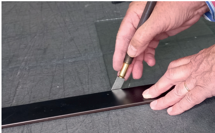
Fig. 102 - Processos de produção dos protótipos: processos de produção da escala de vidro plano (corte manual).
