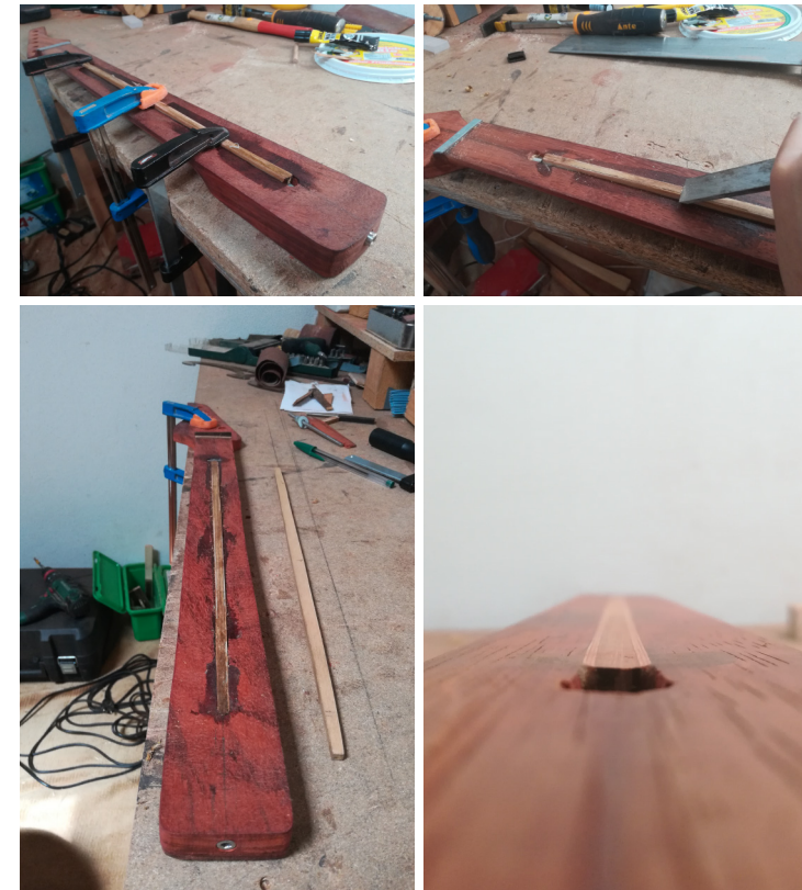
Fig. 97 - Processos de produção dos protótipos: fixação, colagem e acabamento de entalhe central para cobertura de truss rod .
