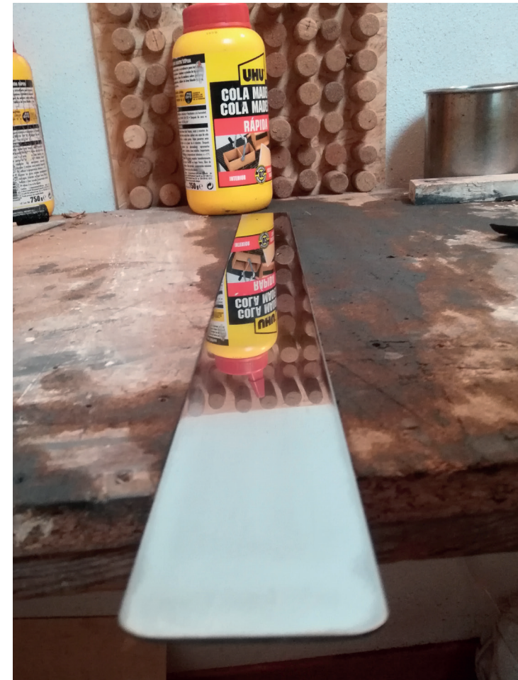
Fig. 101 - Processos de produção dos protótipos: resultado do polimento da escala de chapa de aço.
