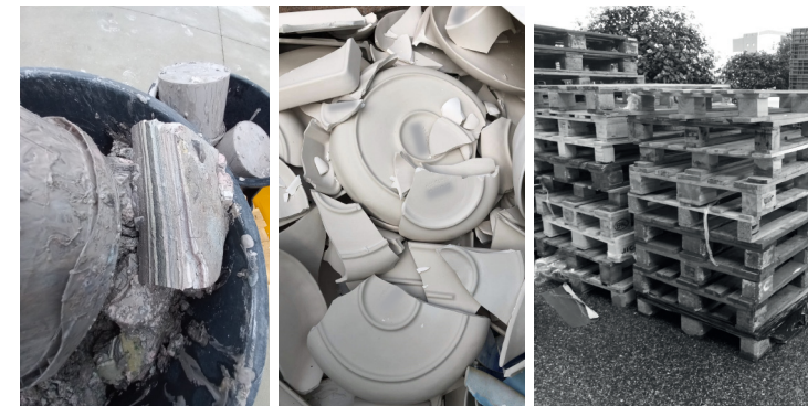
Fig. 31 - Desperdícios de vidrados, peças com quebra e paletes com tábuas partidas (empresa de cerâmica local) - Caldas da Rainha.
