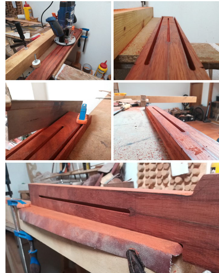
Fig. 89 - Processos de produção dos protótipos: corte da forma do braço e entalhe para truss rod .
