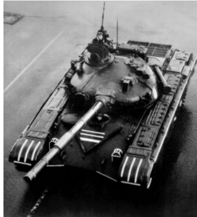
Figura 10 - Exemplo de Tanque de Guerra que utiliza Diferential Steering [19]
