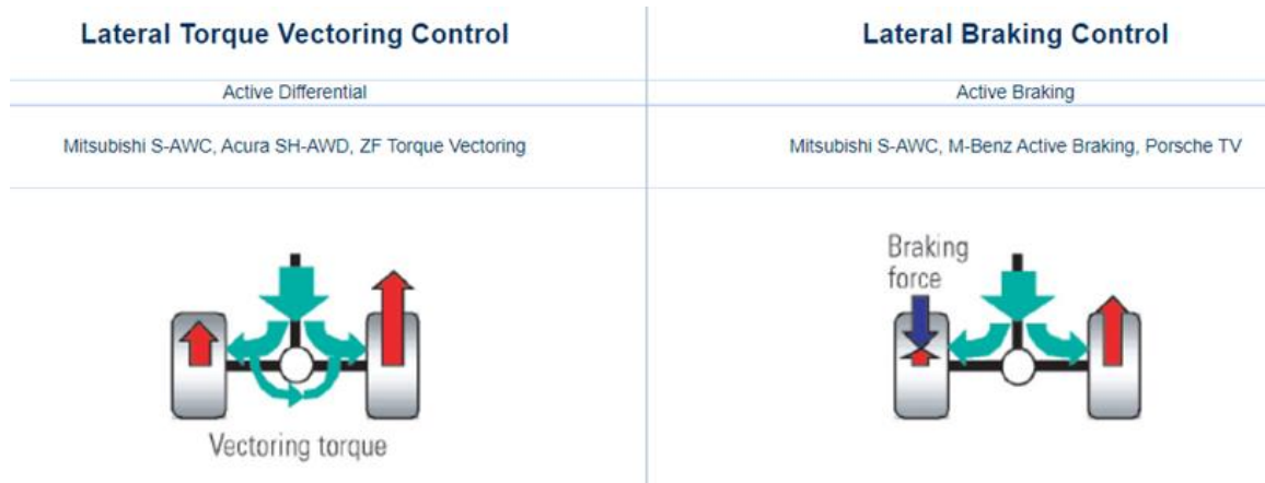
Figura 8 – Torque Vectoring vs Controlo de Travagem Lateral [14]
