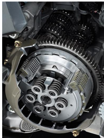
Figura 67 – Embraiagem Multi-Disco em banho de óleo [56]
