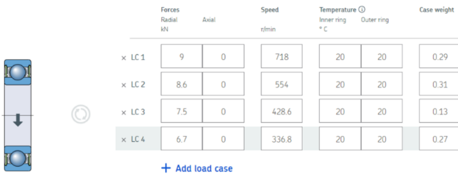
Figura 77 – Espectro de carga – Rolamento SKF® 6010 – 2RS1 [62]
