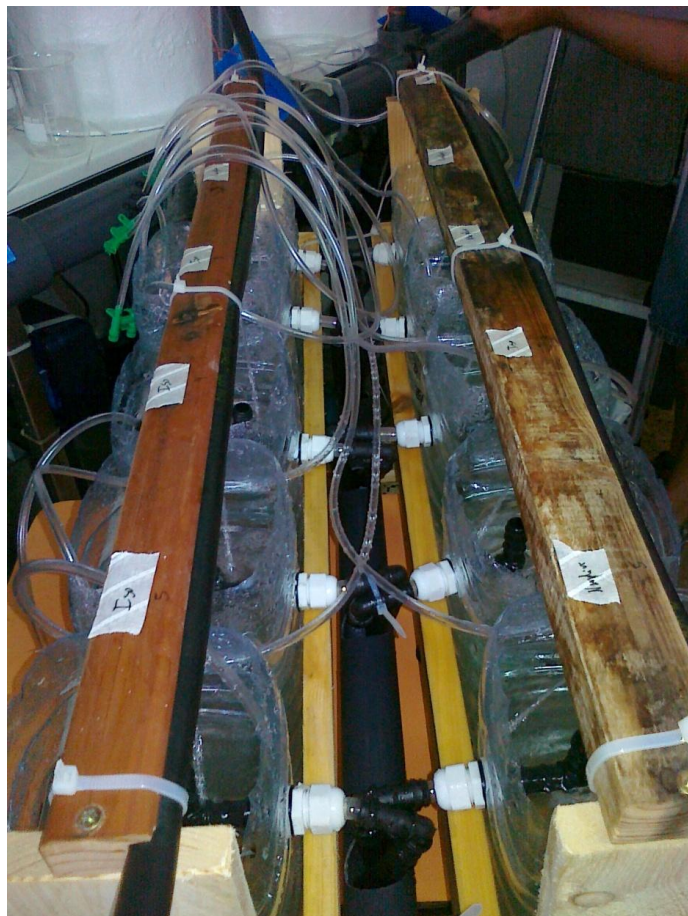
Figura 2.6 – Sistema de recirculação de água utilizado no cultivo larvar. Com entrada de água no topo e arejamento de fundo
