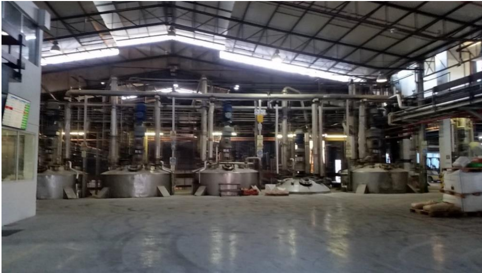
Figura 14 – Reatores onde ocorrem as reações químicas
