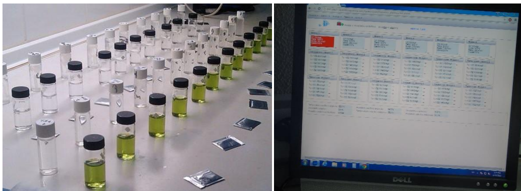
Figura 7- Determinação da concentração de amônia e nitritos (Esquerda) e computador responsável pelos alarmes de oxigênio (Direita). (Fonte: própria)
