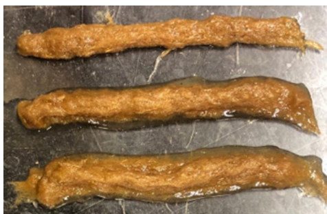
Figura 32 - Deposição 1, 2 e 3 camadas da Formulação F1 (225g Silicato de Sódio +10g de Partículas de Madeira
