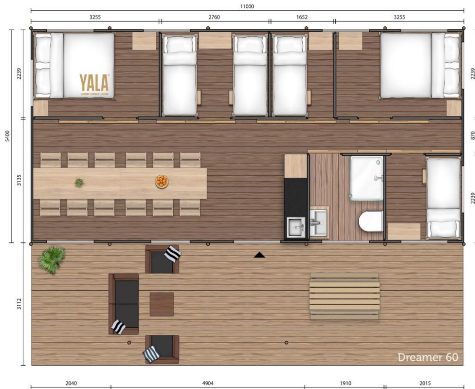
Figura 24- Planta elucidativa da infraestrutura principal- Tenda DREAMER 60
