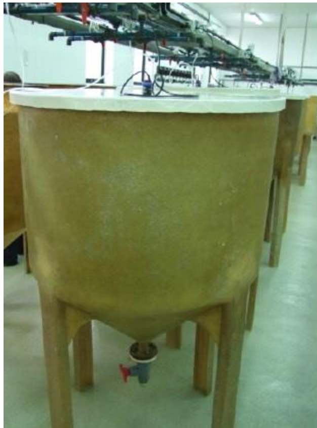
Figura 6 – Tanques cilindro-cônicos de 500 litros, utilizados nos cultivos larvares realizados para a amêijoamacha Venerupis corrugata (Gmelin, 1791) e a amêijoacão Polittapes aureus (Gmelin, 1791).
