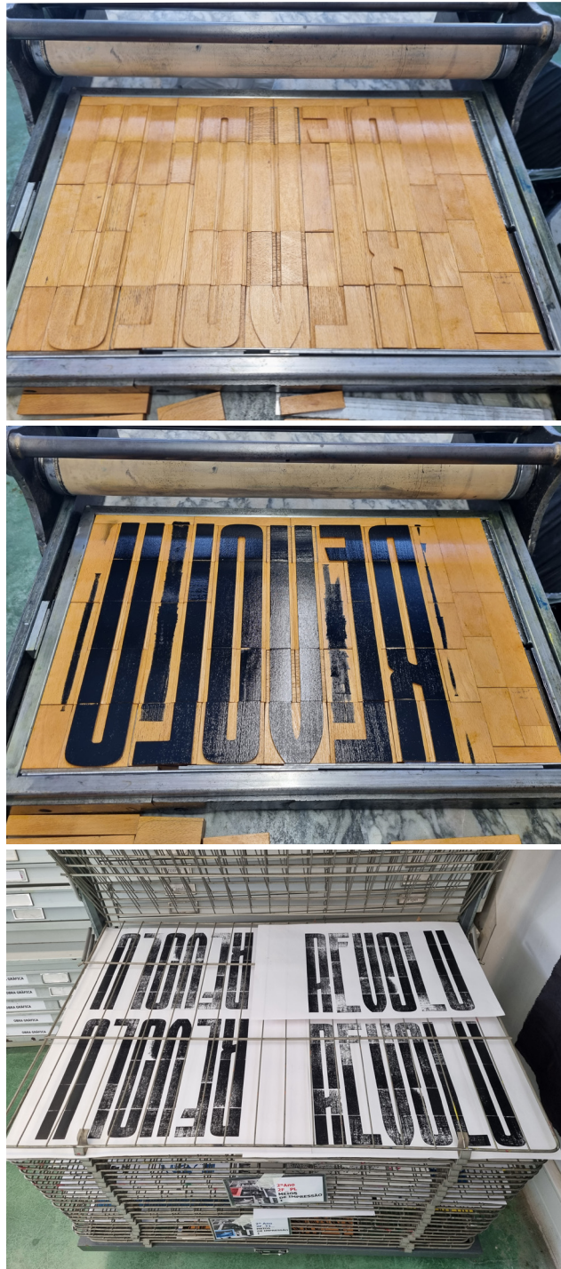
Fig. 46) Processo de impressão no prelo de provas na oficina da ESAD.CR. (imagem do autor).
