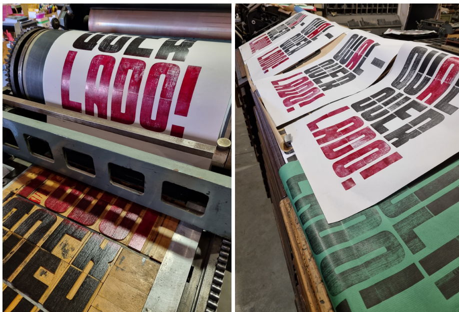
Fig. 44) Esquerda: Impressão a duas cores no prelo cilíndrico; Direita: Resultados impressos (imagem do autor).
