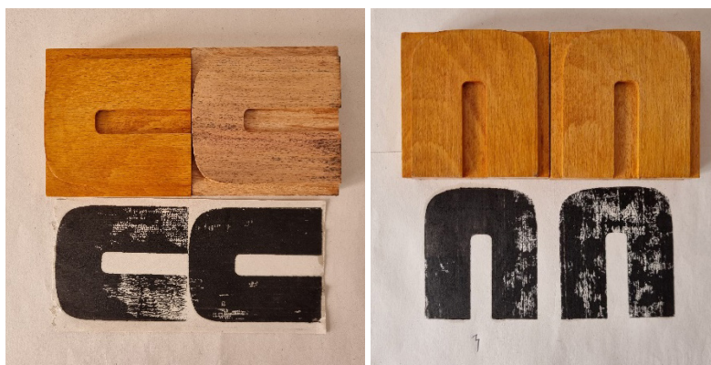
Fig. 31) Esquerda: Última impressão, aplicado no tipo três camadas de goma-laca (esquerda) e noutro de verniz (direita) (imagem do autor). Fig. 32) Direita: Última impressão, aplicado no tipo duas camadas de goma laca e uma de verniz (esquerda) e noutro uma passagem de goma laca e duas de verniz (direita) (imagem do autor).
