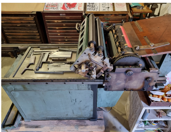
Fig. 36) Prelo cilíndrico vandercook no espaço Artes e Letras Atelier (imagem do autor).
