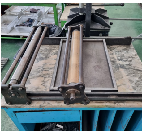
Fig. 35) Prelo de provas na oficina ESAD.CR. (imagem do autor).
