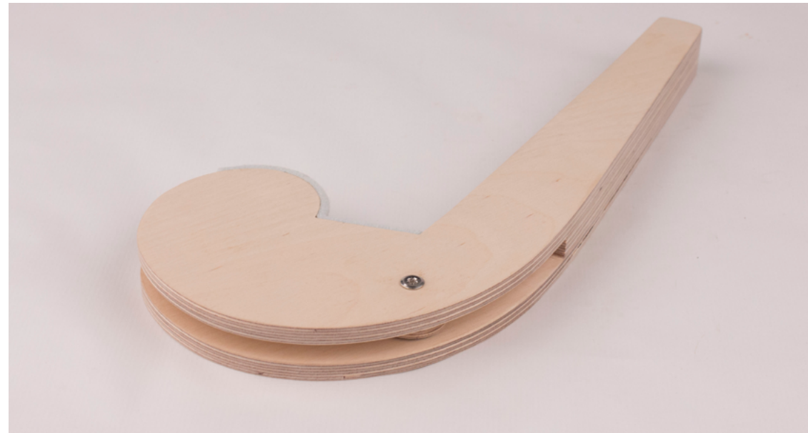
FIG. 91 Ferramenta auxiliar para o desencaixe das peças mais justas
