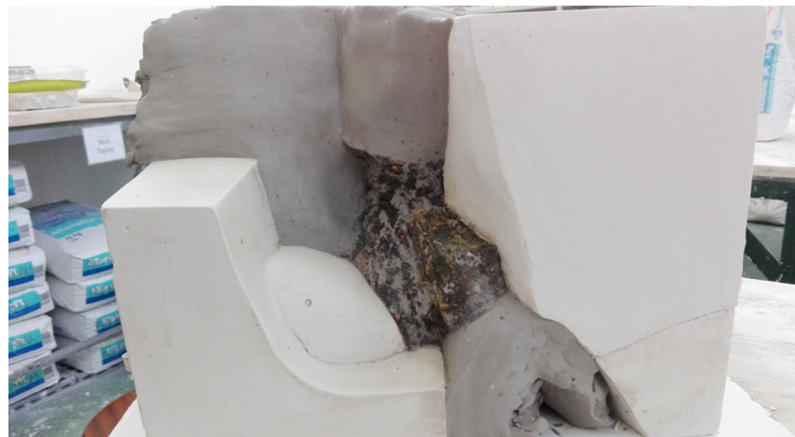
FIG. 46 Construção do molde, suporte para legumes
