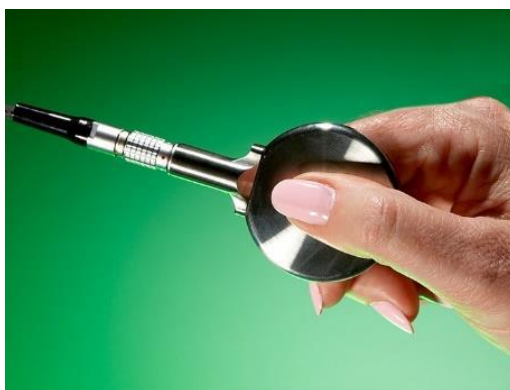
Figura 4. Pinchmeter P200 do Biometrics® E-Link. Em forma de disco permite registrar a força na sua zona central. Imagem retirada de www.deltason.com .
