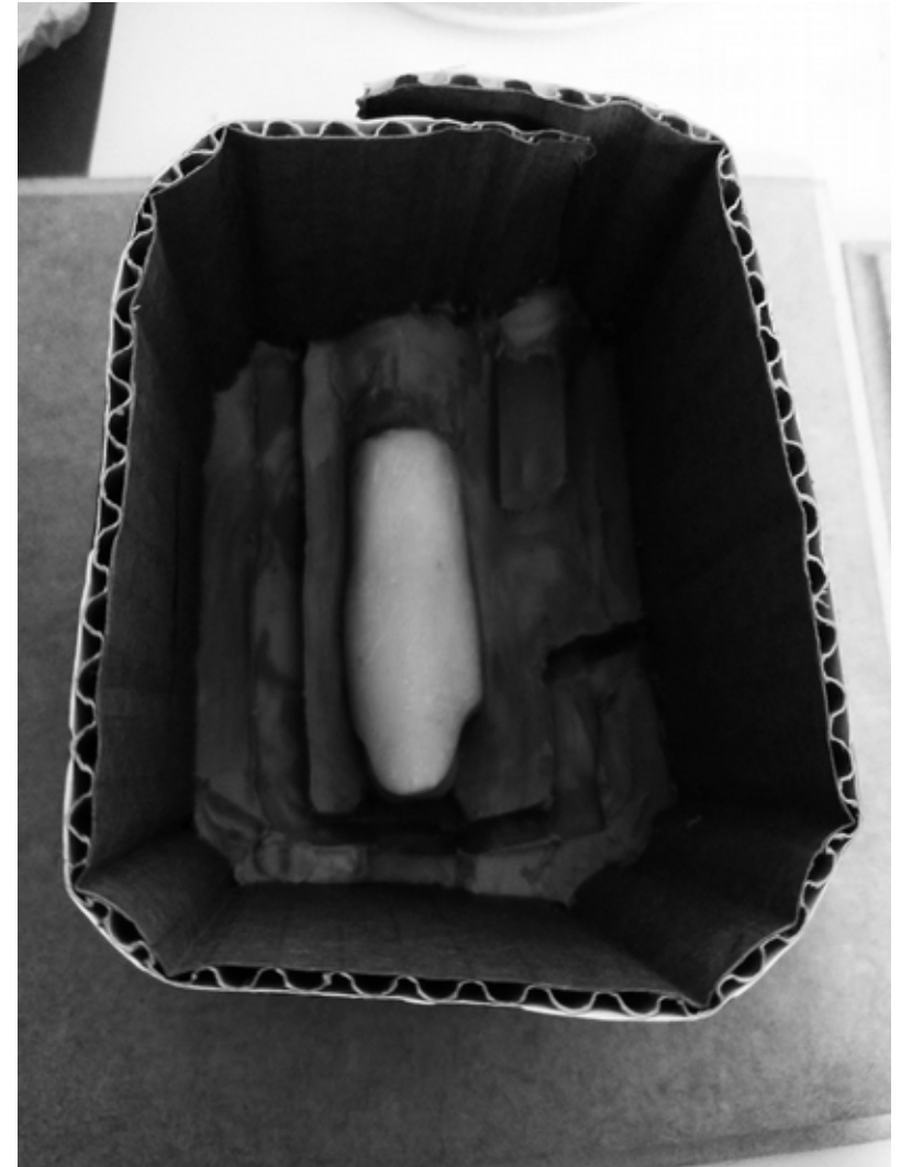
Figura 58: Preparação de um molde bipartido
