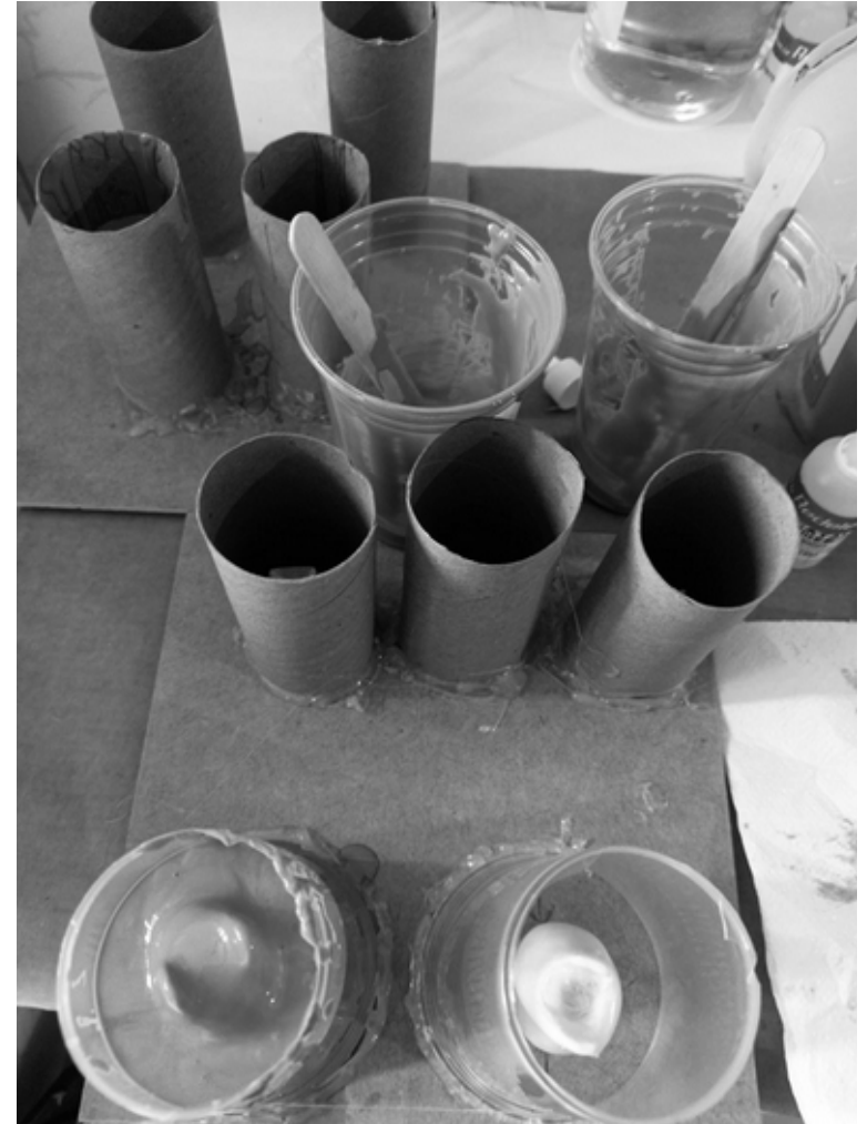
Figura 55: Execução dos moldes de bloco em silicone
