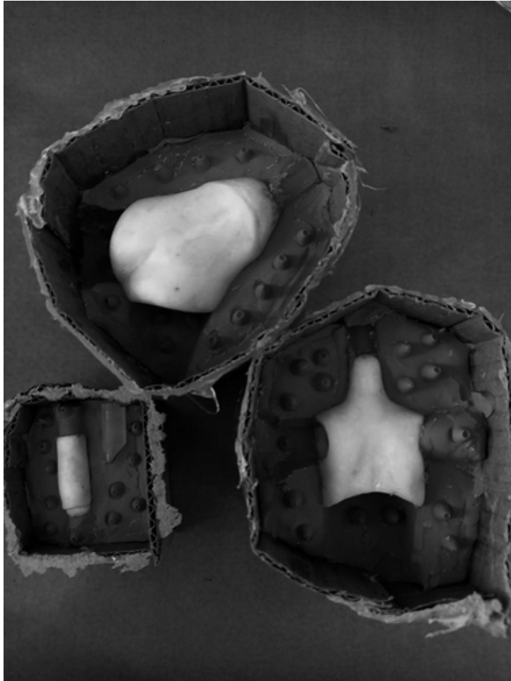
Figura 59: Moldes bipartidos parcialmente concluídos
