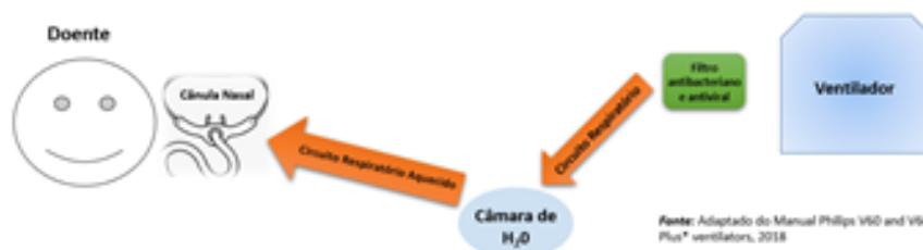
Figura 3: Montagem do circuito ONAF no ventilador V60 ® Plus ventilator Plus
