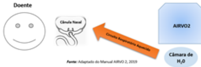
Figura 4: Montagem do circuito ONAF do AIRVO2
