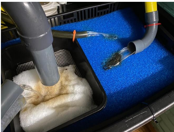
Figura 13. Uso de esponjas para filtração da água
