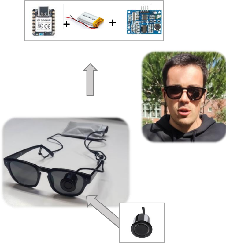
Figura 2 - Estrutura do Módulo Sensorial do sistema SafeSteps
