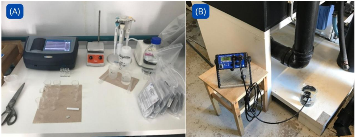
Figura 28: Monitorização da qualidade da água (A) pelo espectrofotómetro e respetivos reagentes (B) medição da concentração de CO 2 dissolvido.
