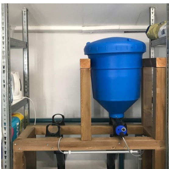
Figura 8: Alimentadores automáticos situados no piso superior do armazém.
