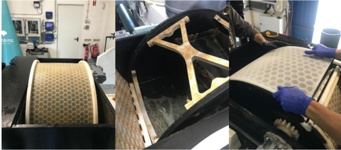
Figura 35: Substituição da malha do filtro rotativo.
