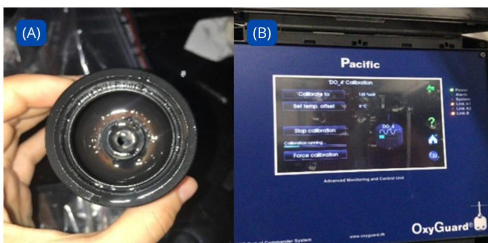
Figura 21: Manutenção das sondas de oxigénio com (A) membrana interna danificada e (B) calibração no Oxyguard .
