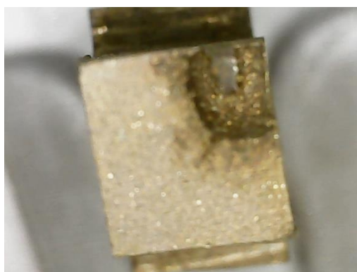
Figura 86: Representação ampliada da secção de bolha apresentada no provete de bronze.
