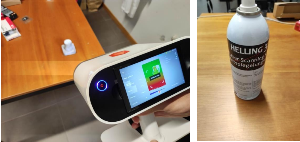
Figura 96: Registo da digitalização e do spray utilizado na preparação do postigo para o este procedimento.
