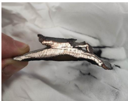
Figura 69: Corte na amostra na qual foi realizada a infiltração do cobre na liga W722
