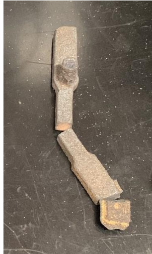
Figura 73: Penetração parcial de cobre para 10 horas de exposição a 1150°C.
