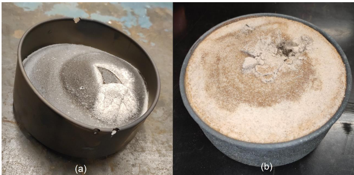
Figura 62: (a) Bronze não infiltrado; (b) Pó do metal base 16316D.04 não infiltrado pelo Bronze.
