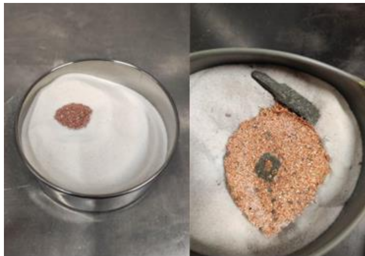
Figura 65: A 1250°C em atmosfera de hidrogénio o cobre não fundiu e o 16316D.04 sinterizou.
