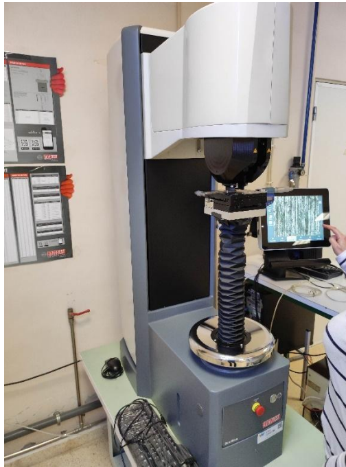
Figura 78: Máquina DuraVision G520/30 utilizada para testes de dureza.
