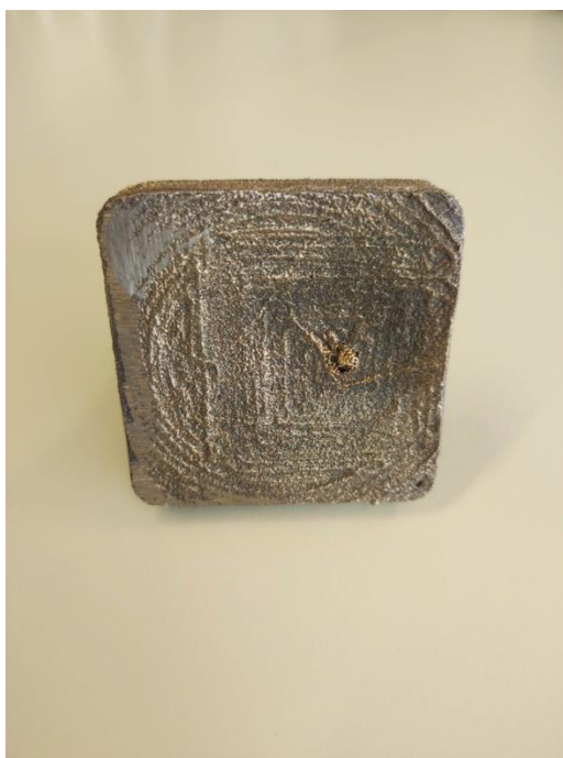
Figura 92: Postilo impresso em W722 e infiltrado por bronze.
