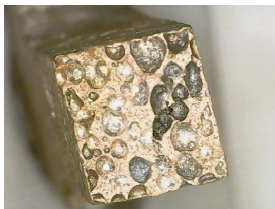
Figura 85: Representação ampliada de bolhas apresentadas em alguns provetes de cobre.
