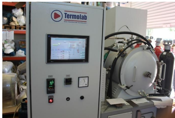
Figura 56: Representação do forno Termolab modelo Vácuo Ref. 304/20.
