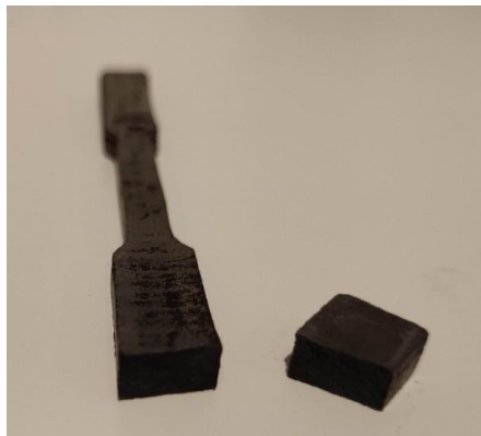
Figura 75: Penetração parcial de bronze para 8 horas de exposição a 1050°C.
