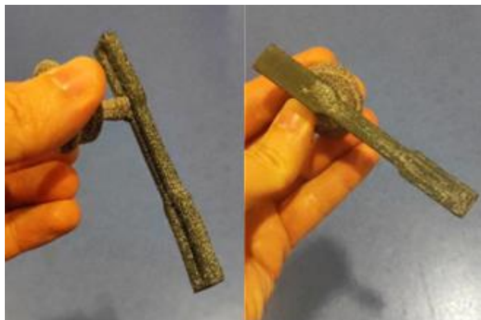
Figura 70: Primeiro provete em W722 infiltrado parcialmente por cobre da LPW.
