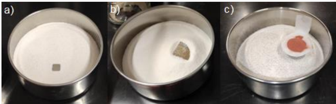
Figura 48: Representação do preparativo do processo de infiltração.
