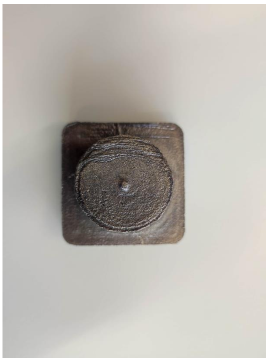
Figura 91: Postilo impresso em W722 e infiltrado por bronze.
