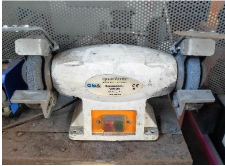
Figura 61: Esmeril modelo Quantum doppelschleifer QMS150 (Fonte:CDRSP-IPL).
