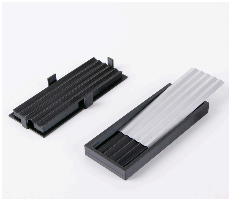
Fig.127 Moldes para prensagem da chapa
