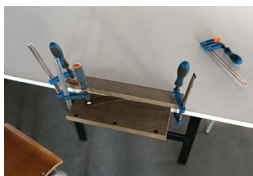
Fig.85 Quinagem do suporte de fita-cola com recurso a duas peças de Valchromat
