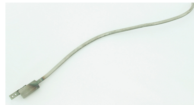
30 - Estrutura da cauda em varão de aço.
