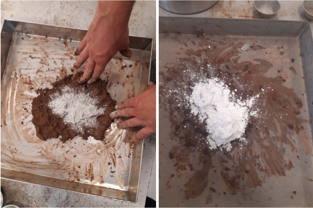
Figura 3.7 - Incorporação de materiais ao solo saturado. Esq. - Solo saturado + 10% pó de granito; Dir. - Solo saturado + 3% de cal.
