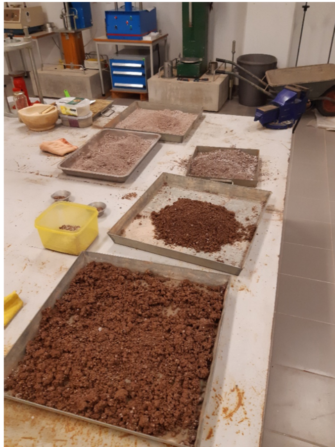
Figura 3.8 – Preparação das amostras para realização do ensaio de Proctor
