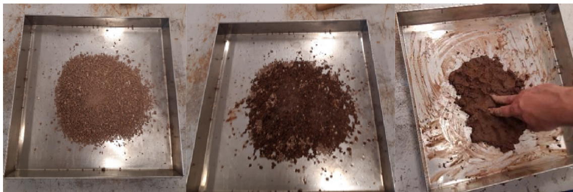
Figura 3.6 – Saturação de amostra de solo. Esq. - Amostra de solo seca em estufa; Centro - Amostra de solo com água adicionada; Dir. – Amostra de solo saturada e homogeneizada.
