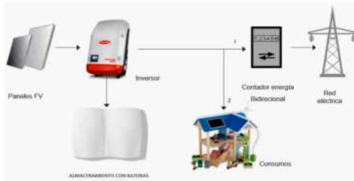
Fig. 3. 8: Instalación de autoconsumo conectado a la red con baterías. (Fuente: (López, 2015))
