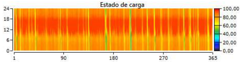
Fig. 5. 10: Estado de carga de la batería de Plomo durante un año. (Fuente: Homer)
