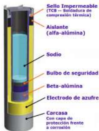
Fig. 2. 8: Estructura de Batería Sodio-azufre. (Fuente: http://e-archivo.uc3m.es/handle/10016/8206#preview )
