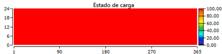
Fig. 5. 22: Estado de carga de las baterías durante un año. (Fuente: Homer)
