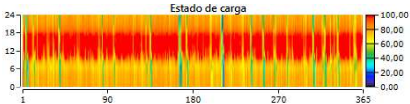
Fig. 5. 10: Estado de carga de la batería de Plomo durante un año. (Fuente: Homer)
