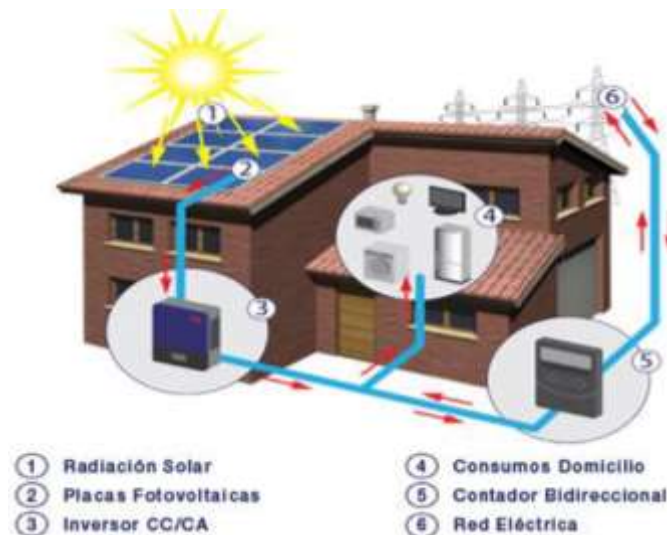
Fig. 3. 3: Instalación fotovoltaica de autoconsumo. (Fuente: (Arévalo, 2016))
