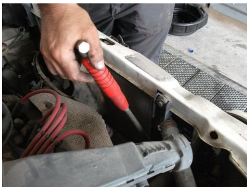
Figura 3.8 - Remoção do líquido de refrigeração do VFV.
