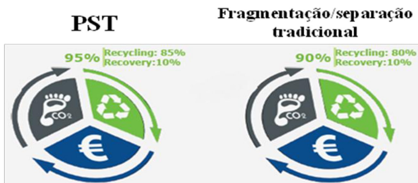
Figura 4.6 - Comparação da taxa de reciclagem e valorização resultantes do PST e da fragmentação/separação tradicional (Ecotest, 2011).
