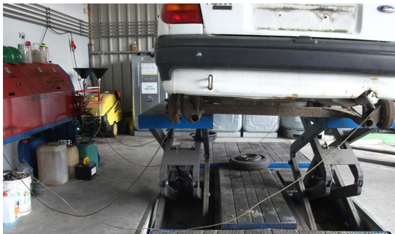
Figura 3.11 - Remoção do fluido dos travões da traseira e da dianteira do VFV.
