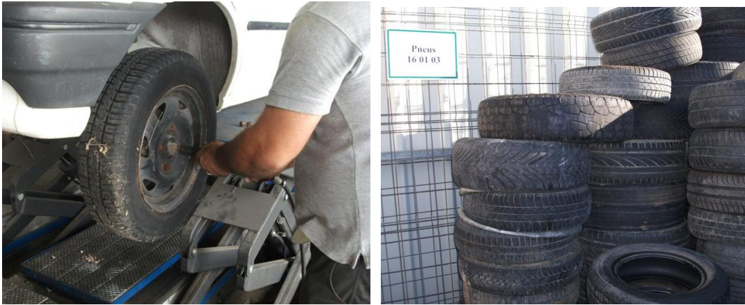
Figura 3.9 - Remoção dos pneus do VFV e seu armazenamento para reciclagem.
