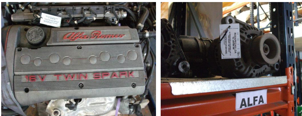
Figura 3.21 - Motor e alternador identificado com etiqueta, armazenado em prateleira adequada.
