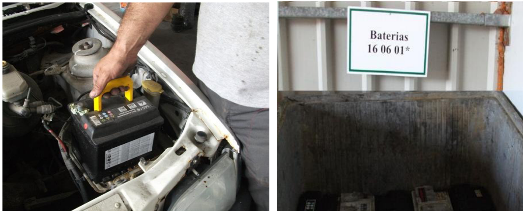
Figura 3.7 - Remoção da bateria do VFV e armazenamento em caixa estanque.
