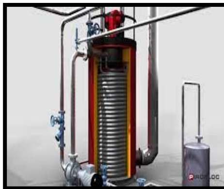
Figura 20 - Caldera de Fluido Térmico.
