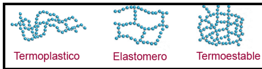
Figura 3 - Clasificación de los plásticos por su estructura interna.
