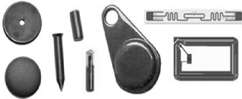
Figura 2-5: Tipos de tags passivas [13].
