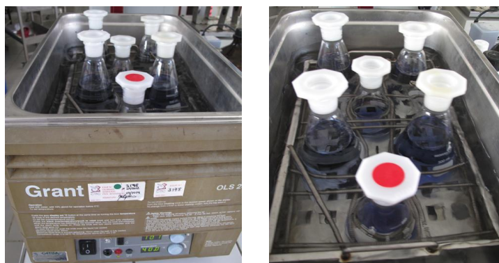
Figura 12 – Ensaio de sorção realizados em processo descontínuo ( batch ).
