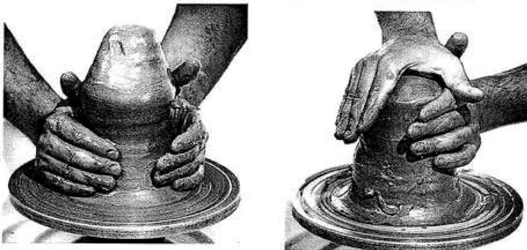
Figura 11 Subir Descer - Ribas, R. (s.d.). Manual de técnicas de conformação à roda . Centro de Formação Profissional para a Indústria Cerâmica
