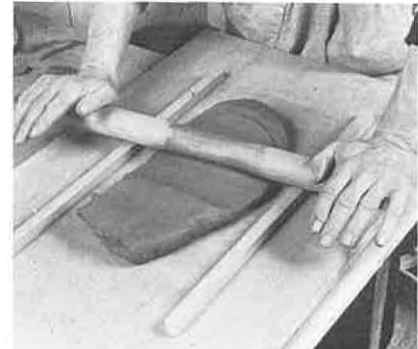
Figura 8 Realização de uma Lastra com Rolo - Casson, M. (1992). Alfarería artesana . EDICIONES CEAC, S.A
