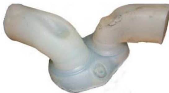
Figura 94 Modelo em silicone das portas de admissão e escape e da câmara de combustão
