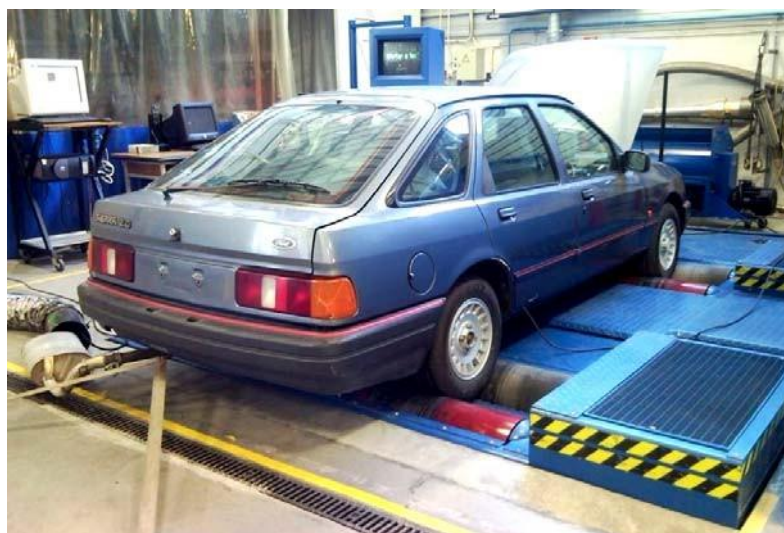
Figura 97 Banco de ensaio de Potência e veículo utilizado
