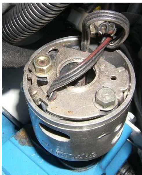
Figura 95 Distribuidor modificado com sensor de PMS
