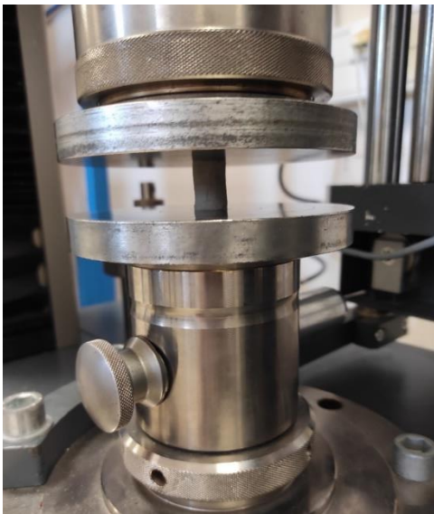
Figura 11 Provetes durante ensaio de compressão, onde já é possível ver flambagem
