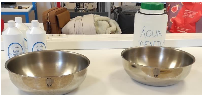
Figura 14 Tina de Soro Fisiológico e Tina de Água destilada, utilizadas para os ensaios de absorção
