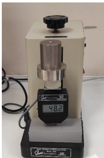
Figura 10 Durómetro de Shore A durante um teste
