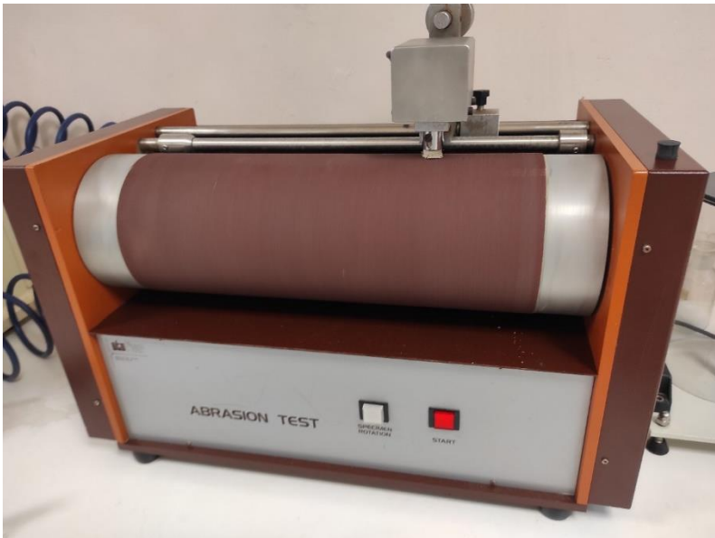
Figura 12 Tambor giratório utilizado no ensaio de abrasão
