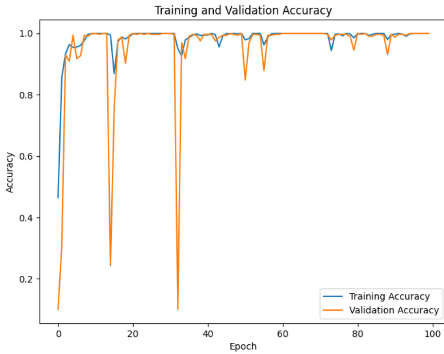
Figura 70 - Comparação da accuracy de treino e validação para o modelo ResNet50 com Augmentation
