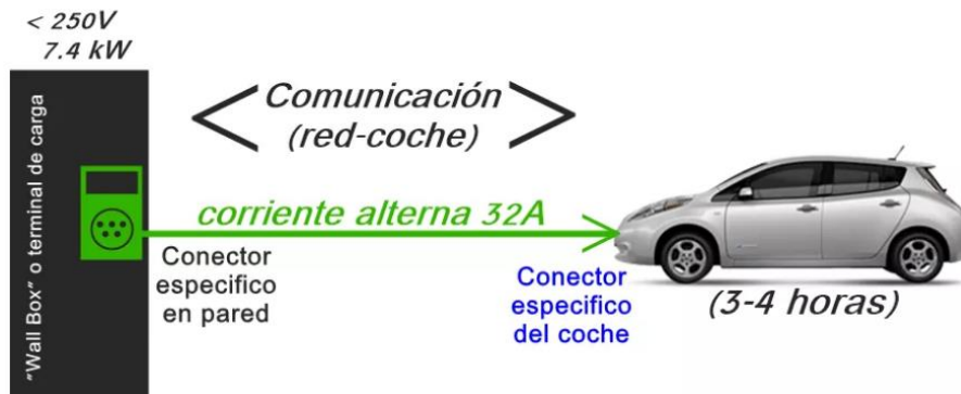
Figura 2-6. Modo de carga 3 [8]
