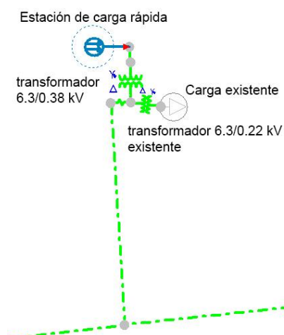
Figura 4-44. Estación de carga rápida en el sistema de distribución
