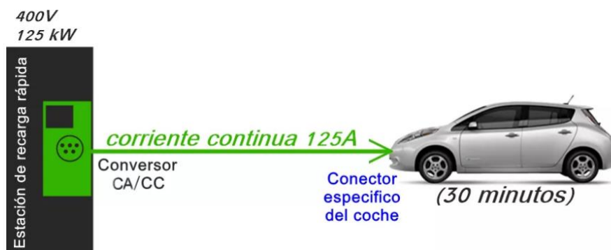
Figura 2-7. Modo de carga 4
