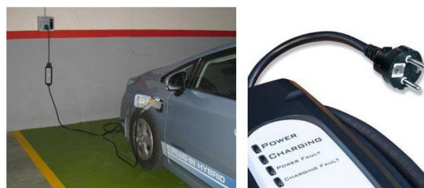
Figura 2-5. Modo de carga 2
