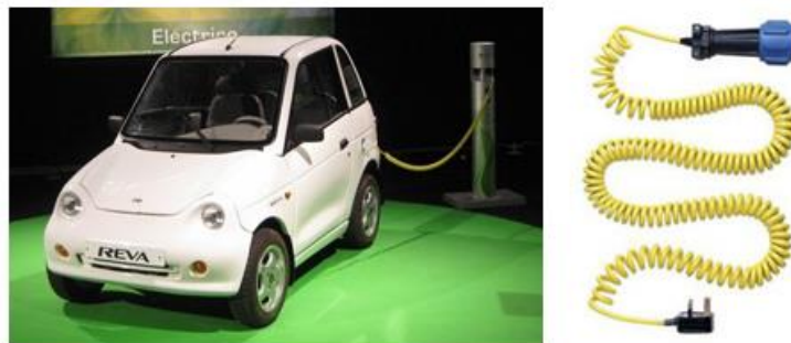
Figura 2-4. Modo de carga 1
