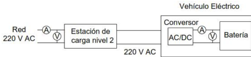
Figura 3-12. Conexión y mediciones
